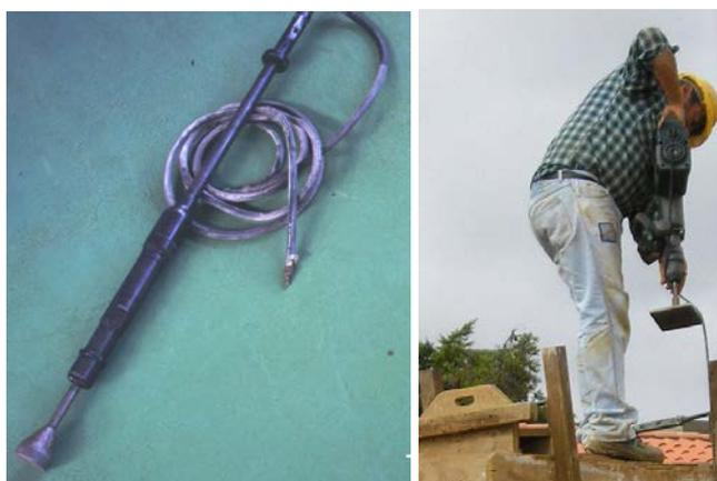
Figura 13 – Exemplos de compactador mecânico.
