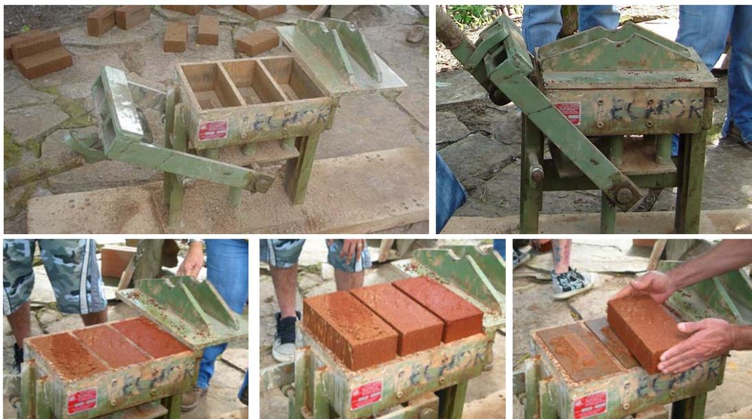
Figura 5 – Moldagem de BTC
