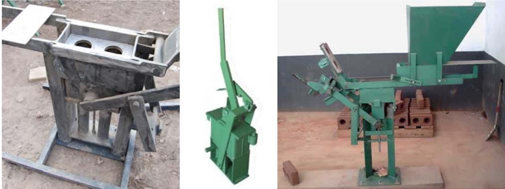
Figura 10 – Prensa Mattone (a la izquierda) y más dos modelos de prensas manuales
