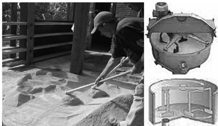
Figura 15 - Preparación de la tierra con la adición de cal y cemento y ejemplos de mezcladoras planetarias
