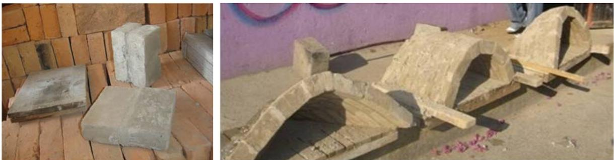
Figura 16 – Prueba de adherencia y muestras de diferentes tipos de bóvedas
