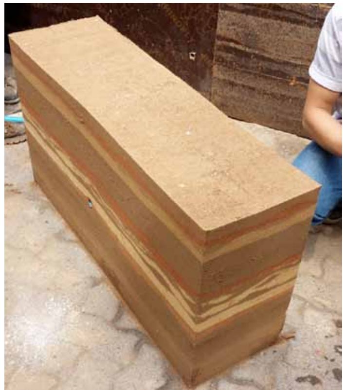
Tapial ejecutado por los alumnos con la ayuda del arquitecto Patricio Arias
