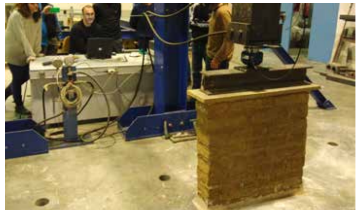
Rotura de un muro de adobe en el laboratorio de la Escuela Técnica Superior de Ingeniería de la Universidad de Sevilla (Créditos: Mario Solís).
