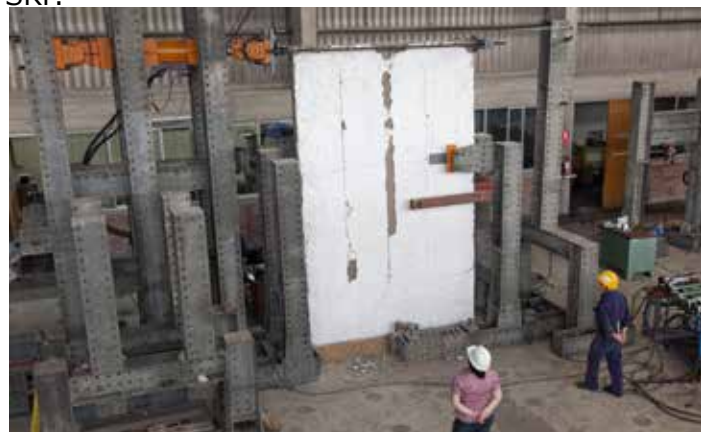
Ensayo de desplazamiento de un panel de quincha reconstruido en la PUCP, Lima, Perú. Diciembre, 2011. (Créditos: Scott Warren, J. Paul Getty Trust).
