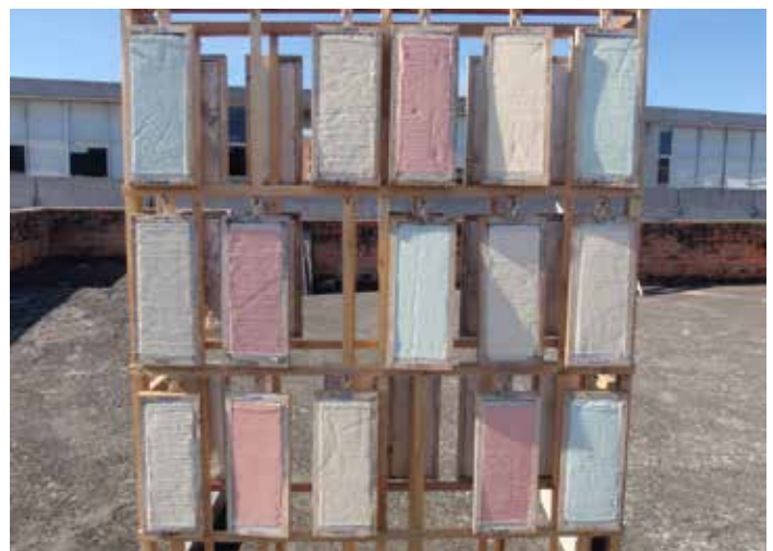
Soportes con pruebas con las dosificaciones de pintura (Créditos: Gabriela Barsallo)
