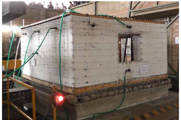
Módulo de vivienda de tapial y sobrecimientos de ensambles de shicras, después del ensayo.
