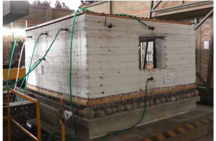
Módulo de vivienda de tapial y sobrecimientos de ensambles de shicras, antes del ensayo.
