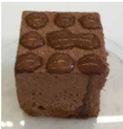
Baixa absorção de água por parte de amostras de reboco de terra biotratado superficialmente (créditos: Ricardo Velez da Silva)
