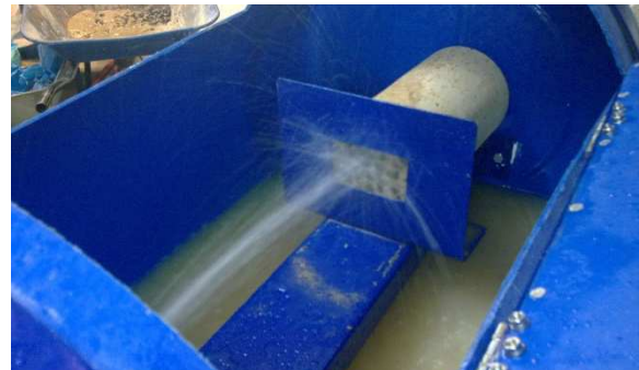
Prueba de erosión de chorro de agua
