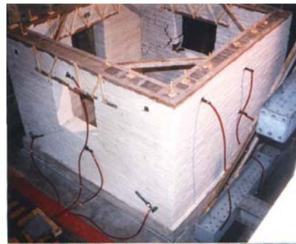
Fig. 15 – Construcción e instrumentación de módulo de adobe con refuerzo de caña.
