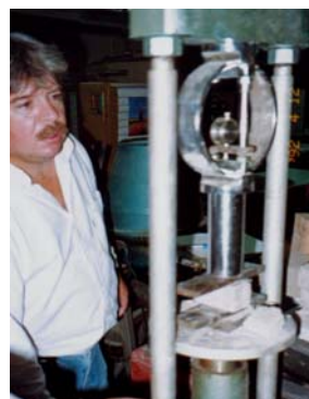
Figura 11: Ensayo de corte sobre probetas (5x5x14) cm.
