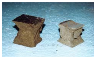
Figura 10: Rotura por compresión en probetas (5x5x14) cm.
