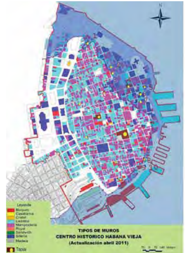
Fig.2 Inventory of wall types, and primary and secondary flooded areas in Old Havana; yellow circles reveal rammed-earth construction (credits: Rodriguez, 2011 - Plan Maestro de la oficina del Historiador de la Ciudad de la Habana, Dirección de Planificación Física Ciudad Habana y CITMA Ciudad Habana, 2006-2011)
