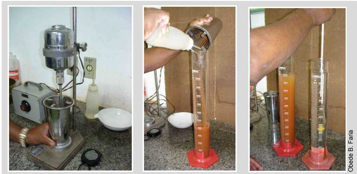
Figura 3 – Ensayo de sedimentación: aparato dispersor; transferencia del suelo disperso para la probeta de 1 litro, y homogeneización de la temperatura del densímetro
