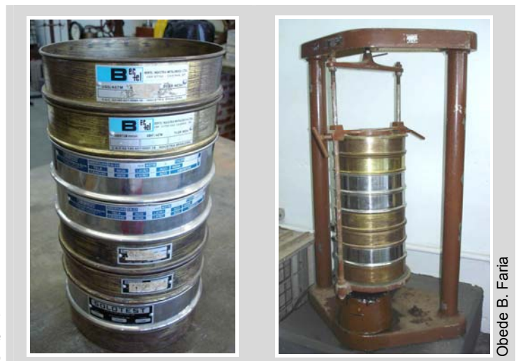
Figura 2 – Ensayo de tamizados: serie de tamices patrón y equipo eléctrico de tamizado
