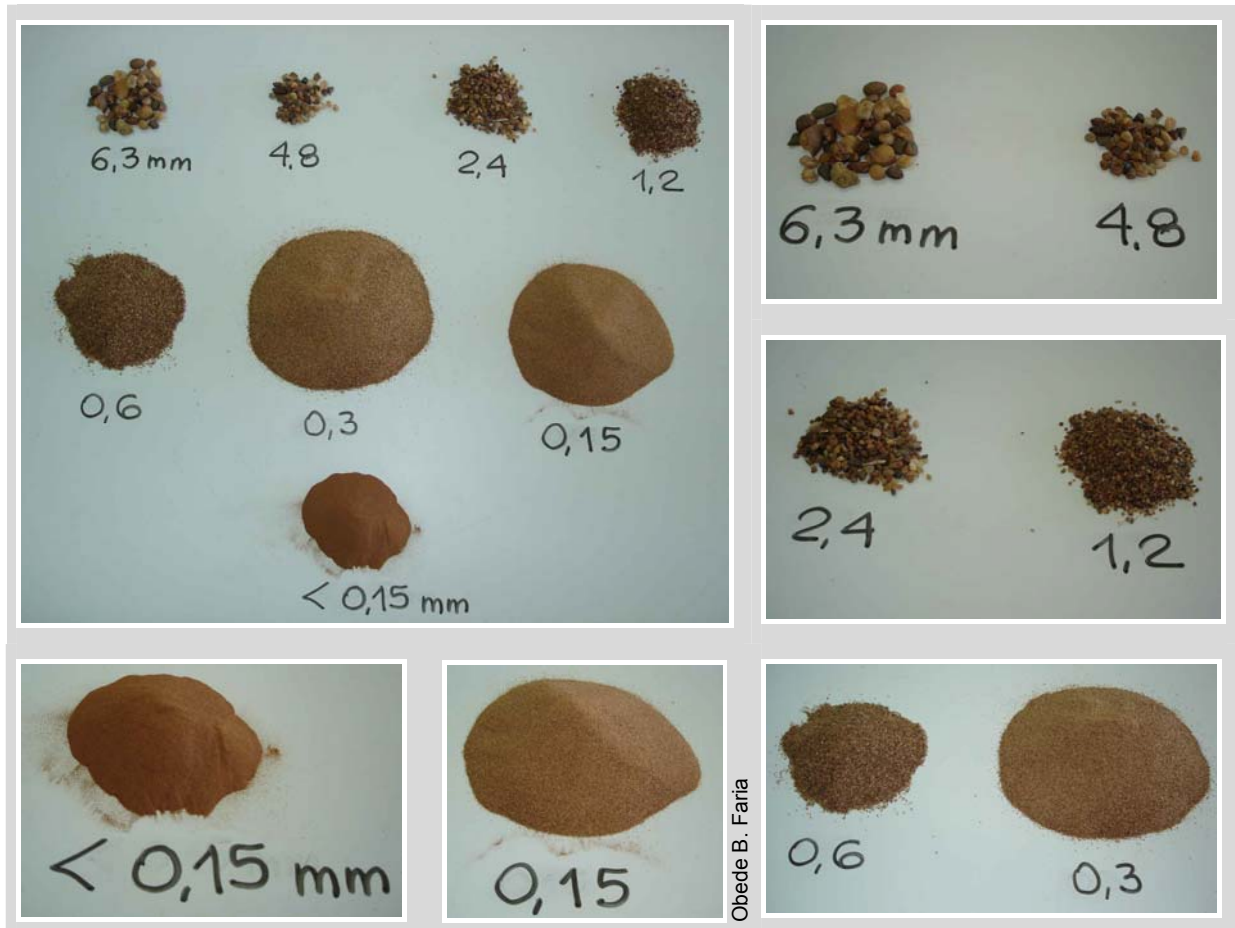
Figura 10 – Aspectos de las partículas que componen la tierra después del tamizado, se observa las fracciones retenidas en cada una de las tamices de la serie normal
