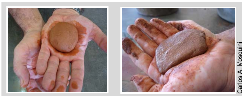
Figura 17 – Test de exudación: diferencia entre una tierra arcillosa (a la izquierda) y una tierra arenosa (a la derecha)
