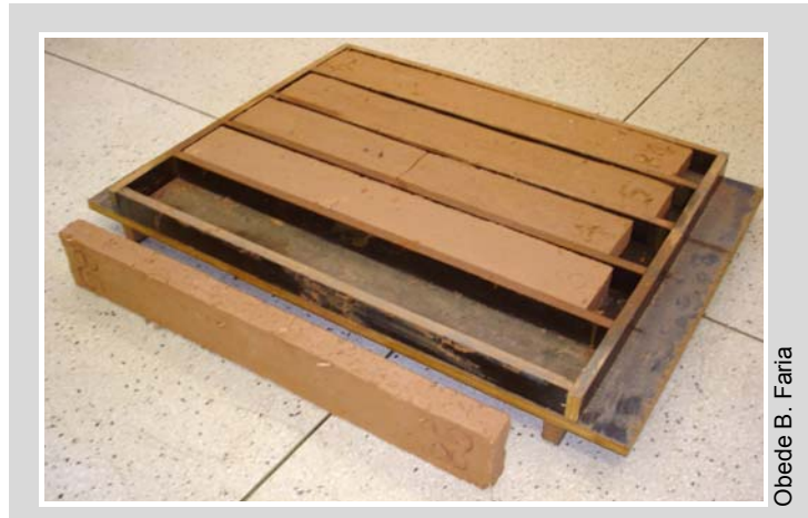
Figura 20 – Ensayo de retracción (el test de la caja): la caja de la ilustración permite el ensayo de cinco muestras, simultáneamente, facilitando la comparación entre los resultados de retracción (cada compartimiento tiene 8,5 cm de ancho, 3,5 cm de altura y 60 cm de largo). Dispositivo propuesto por Faria (2002)
