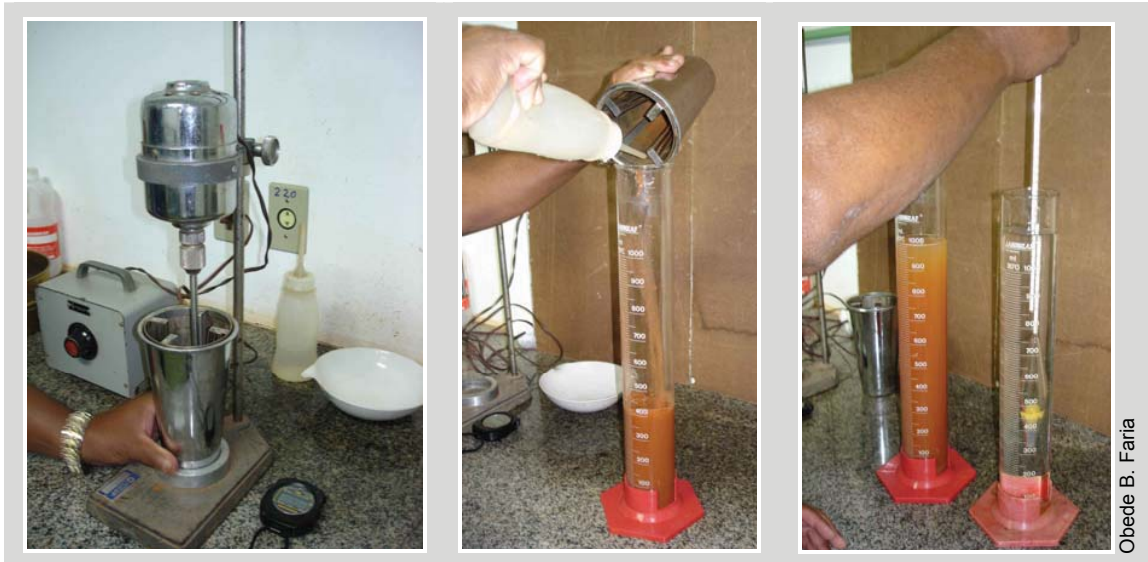
Figura 3 – Ensaio de sedimentação: aparelho dispersor; transferência do solo disperso para a proveta de 1 litro; e, homogeneização da temperatura do densímetro
