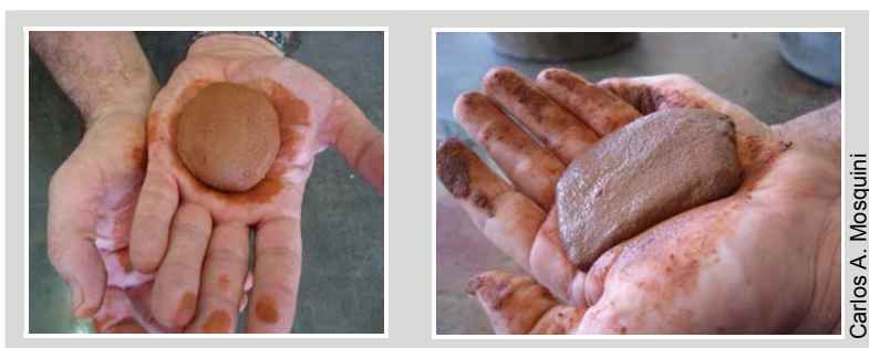
Figura 17 – Teste de exsudação: diferença entre uma terra argilosa (à esquerda) e uma terra arenosa (à direita)
