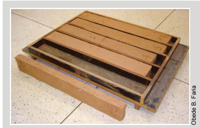
Figura 20 – Ensaio de retração (o teste da caixa): a caixa da ilustração permite o ensaio de cinco amostras, simultaneamente, facilitando a comparação entre os resultados de retração (cada compartimento tem 8,5 cm de largura, 3,5 cm de altura e 60 cm de comprimento). Dispositivo proposto por Faria (2002)
