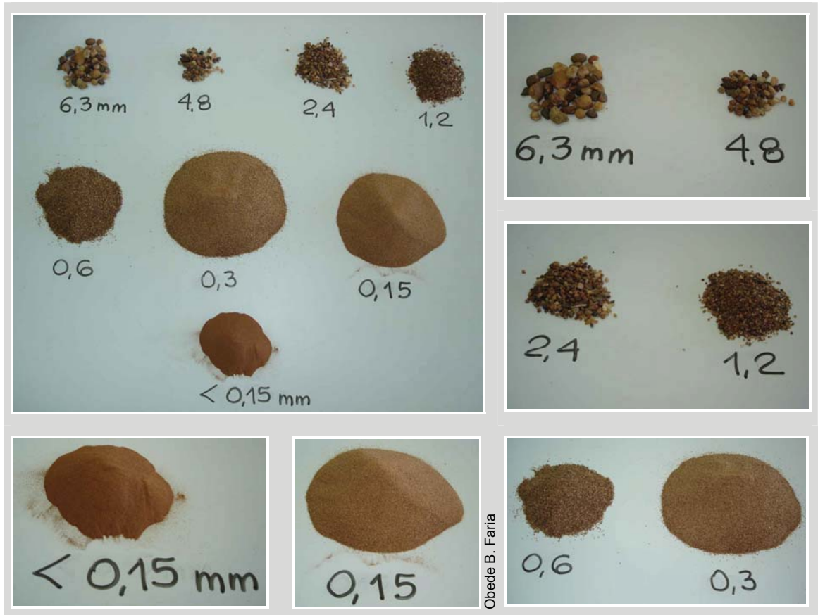
Figura 10 – Aspectos das partículas que compõem a terra. Depois da separação por peneiramento, observam-se as frações retidas em cada uma das peneiras da série normal
