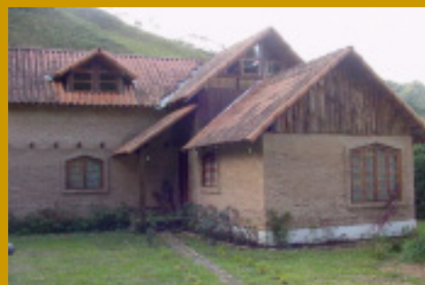
Vivienda en ladrillo prensado con solo cal Vale do Alcantilado – Visconde de Mauá Resende – RJ - Brasil
