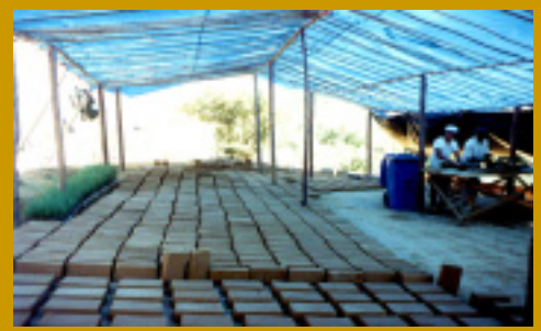
Fabricación de adobes para construcción de vivienda en la región de Visconde de Mauá – Resende – RJ - Brasil
