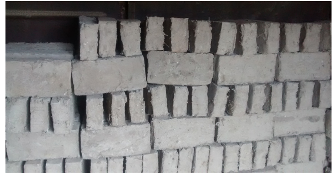
Fig 2a: BTC con cara curva para bovedilla fabricados en la Facultad de Arquitectura, Diseño y Urbanismo FADU UBA.
