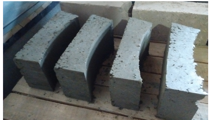
Fig 1b: BTC con cara curva para bovedilla fabricados en la Facultad de Arquitectura, Diseño y Urbanismo FADU UBA.
