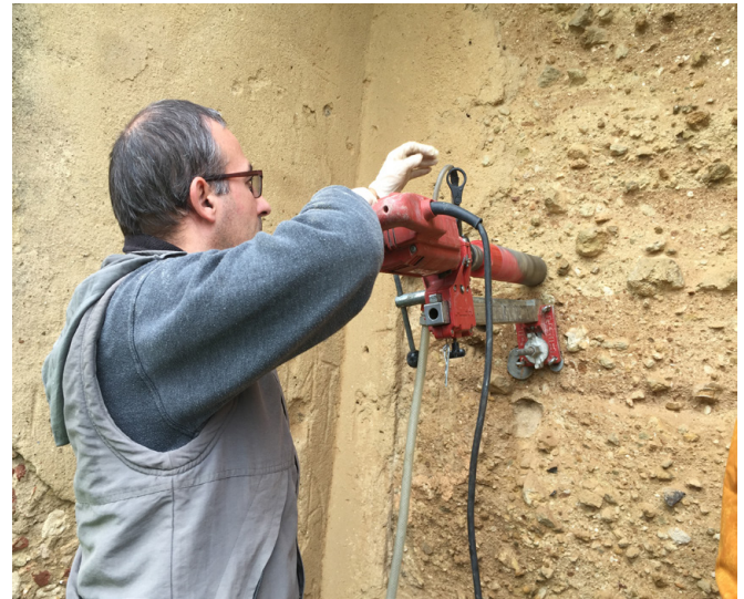
Fig 1: Extração de carote (a) e pormenor de carote extraída Fuente: Faria, 2019
