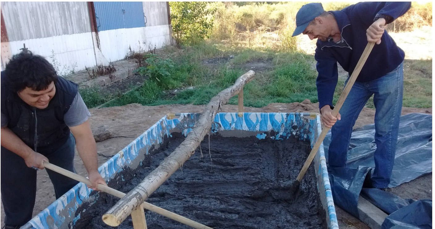
Figuras 2b: Talleres de fabricación de adobes en la Cooperativa Vagues, San Antonio de Areco
