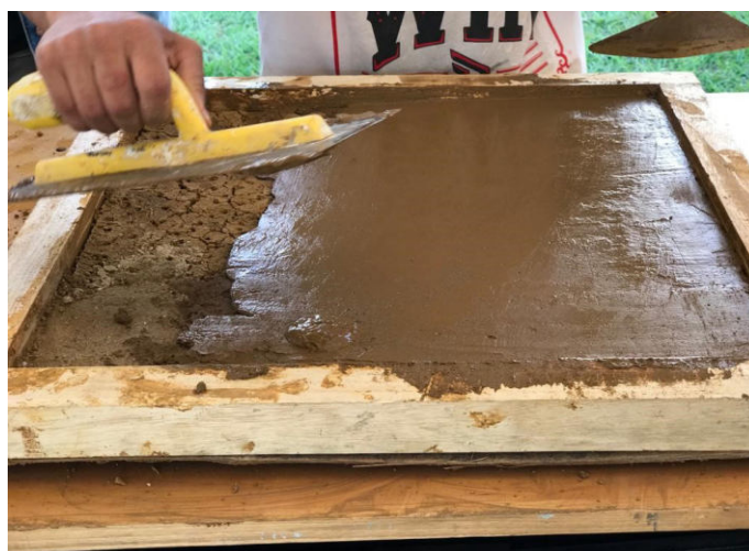
Fig. 3 Experimentos de los revestimientos para paredes de tierra sobre soporte de estera de guadua. Autora: Lucía Garzón
