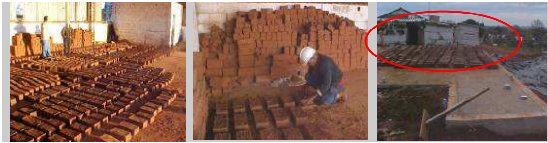
Figura 3 - Fotos da seqüência de produção dos adobes, observando-se no destaque a precariedade da situação habitacional da família, anterior à construção da nova casa.
