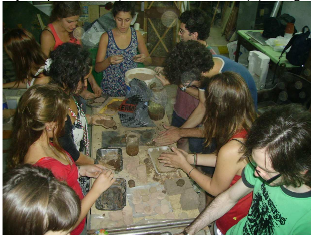
Figura 1: Formación en investigación de alumnos de los últimos años de la carrera Arquitectura en la FADU-UBA, Buenos Aires. Ensayos sensoriales, contracción lineal, evaluación y lectura de ensayos en aula-laboratorio. 2008.
