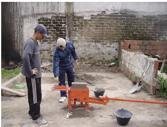
Figura 2: Fabricación de BTC con jóvenes de Bancalari y barrios vecinos. Formación continua para capacitar grupos de vecinos y gestionar mejoramientos de viviendas locales.
