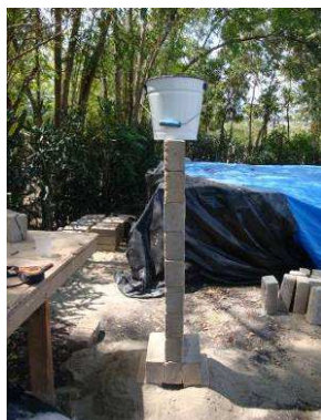
Fig 13. 72,8 kg sin fisuras de mortero. 5 arcilla, 2 de arena, ½ cemento. (créditos: Jim Hallock, 2010)
