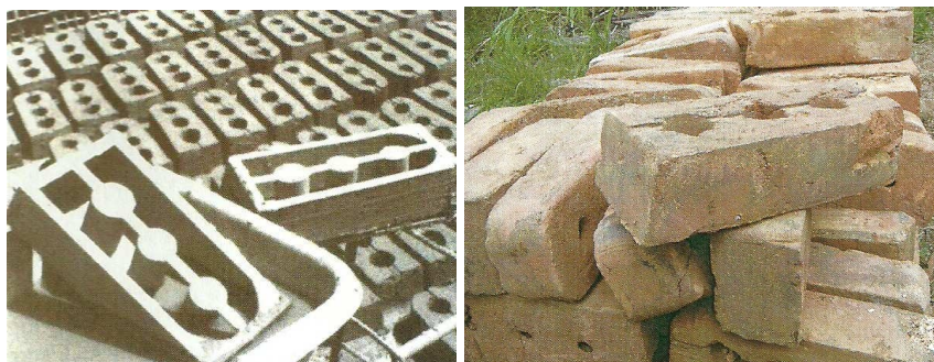
Figura 01: fôrmas metálicas e tijolos resultantes, com propriedades termo-acústicas, utilizados na cúpula do Integria. Fonte: Minke (2008) e Integria.
