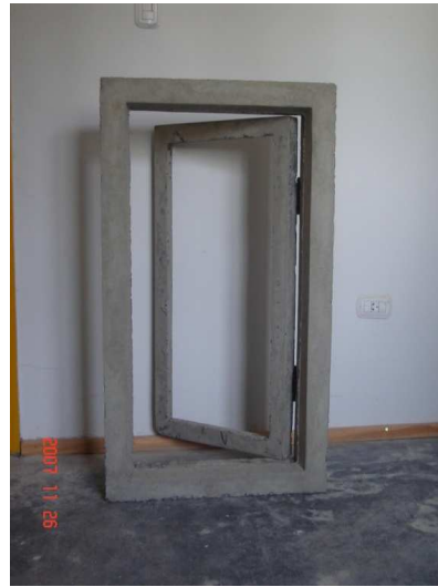
Fig.5 Corte muro-Carpintería de Hormigón Trabajos experimentales en Taller (créditos: Albarracín- Dubos 2010)
