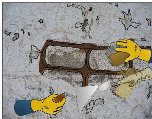
Fig.2 – Limpieza superficial. (Paolo, 2010)
