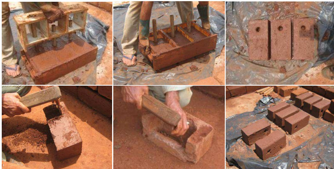
figura.1 – Etapas de la producción del adobe: a) retiro de la forma adaptada; b) desmolde de la forma de 3 adobes dejando los tubos de PVC; c) Adobes sin el tubo de PVC secando al sol; d) corte del adobe para incrustar la caja de tomada o interruptor; e) corte del adobe para incrustar caja de distribución; f) adobes girados secando al sol (créditos: autor)
