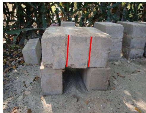
Fig 14. Las líneas rojas muestran las juntas de mortero que se están probando. (créditos: Jim Hallock, 2010)
