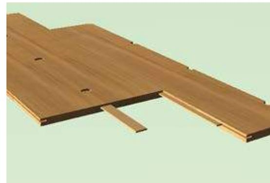
Figura 13. Lamelas de unión paneles CLT
