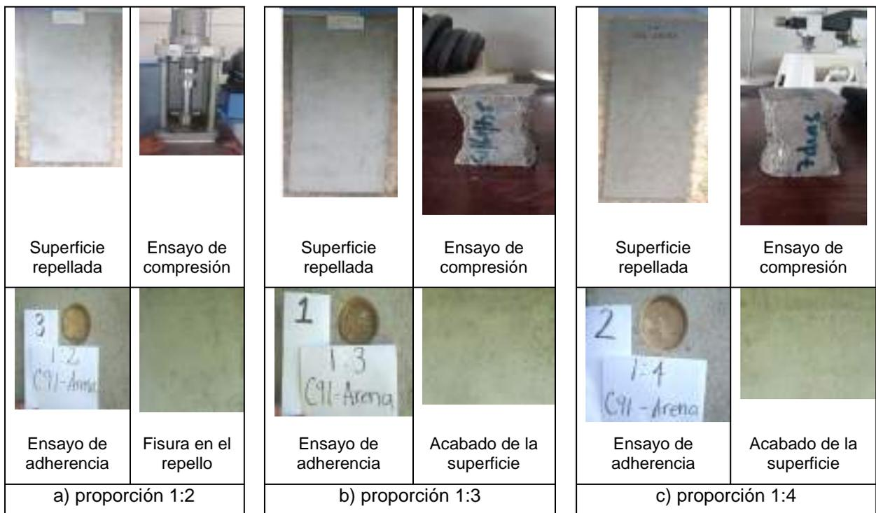
Figura 10. Aspecto de los repellos y ensayos del mortero de cemento y arena en diferentes proporciones
