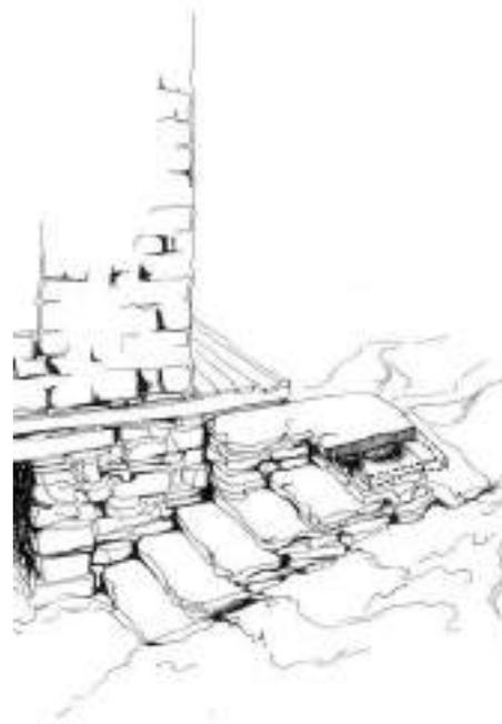
Figura 2. Azuay, Baños. Sistema de aparejo en elementos de piedra en escaleras para adaptarse al relieve del terreno.
