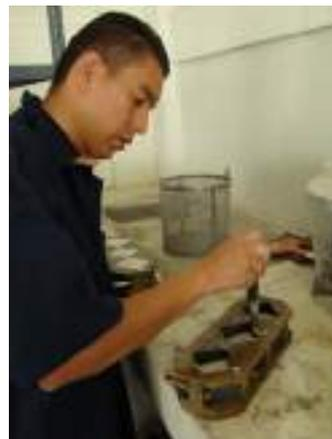
Figura 7. Moldeo de cubos de mortero
