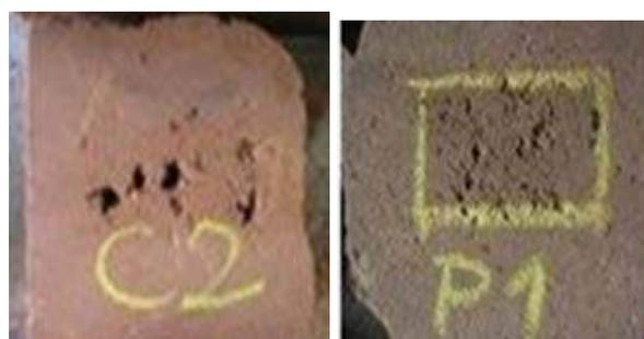
Figura 10. BTC después del ensayo de la erosión
