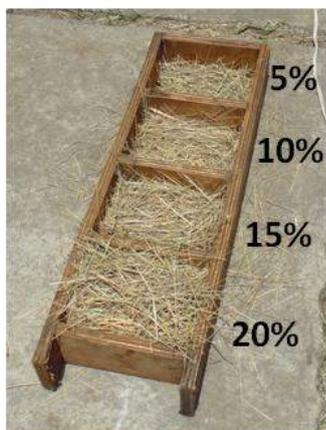
Figura 1. Dosificación mediante porcentajes de volumen de fibra vegetal
