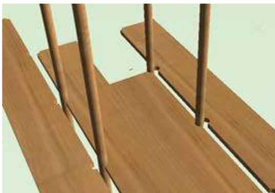
Figura 12. Calce de postes y plataforma CLT
