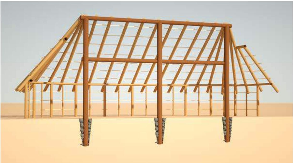
Figura 2. Sistema de postes empotrados al suelo como elementos fundamentales de estabilidad de todo el conjunto
