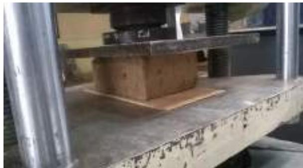
Figura 4. Ensayo a la compresión
