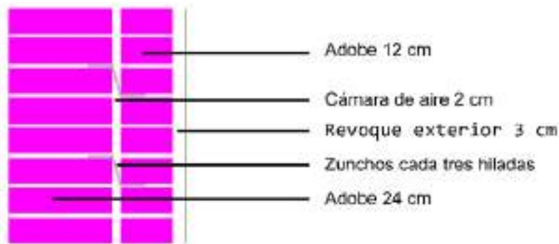
Figura 2 – Detalle del muro doble de adobe
