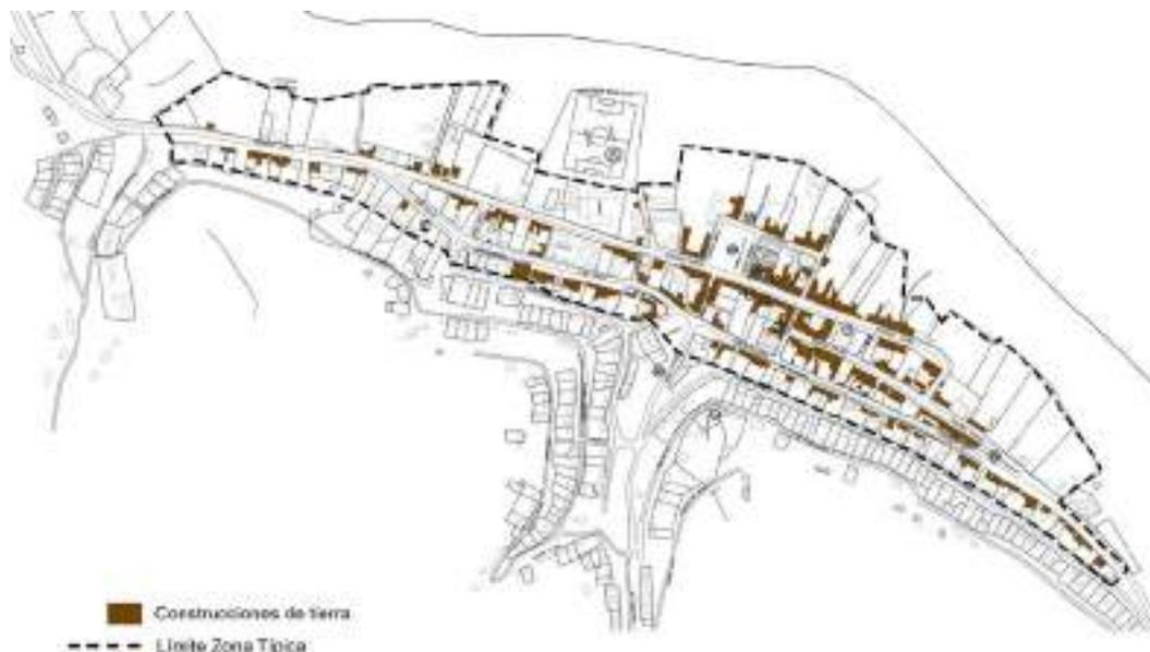
Figura 2. Plano de Canela evidenciando el área denominada como Zona Típica y las construcciones de tierra presentes en ella (Fuente: Dinamarca, 2016)
