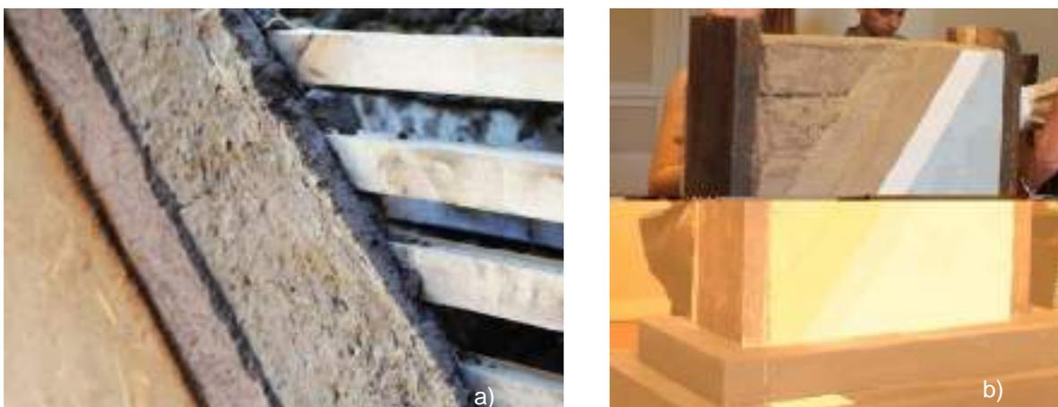
Figura 4. a) Terminación con revoque fino de tierra sobre prototipo con estructura de quincha. b) Prototipo de adobillo con terminación a yeso y papel mural (Crédito: Pilar Silva)
