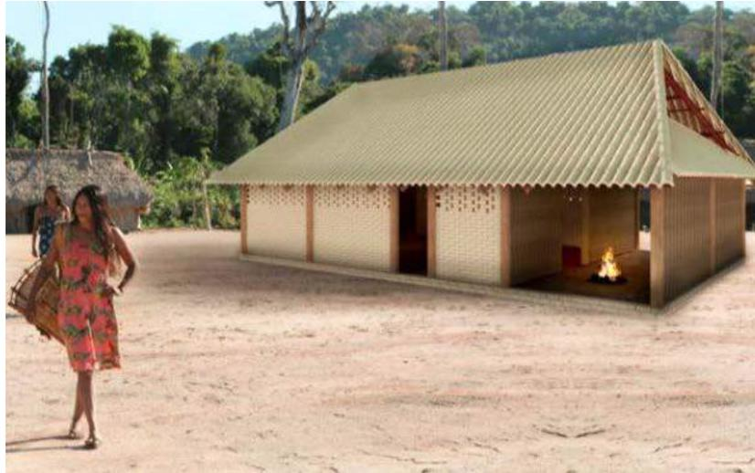
Figura 5. Propuesta en modelo 3d y fotomontaje de casa Kubêngôkre con paredes de BTC y techo de PVC, llevada a campo para desarrollar el proyecto con las comunidades.
