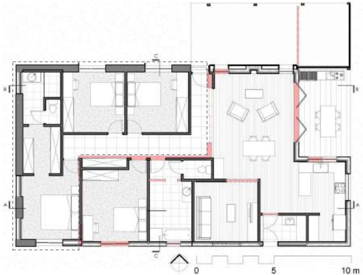
2. Planta baixa de reforma da residência, com a ampliação em tracejado e em vermelho as paredes demolidas
