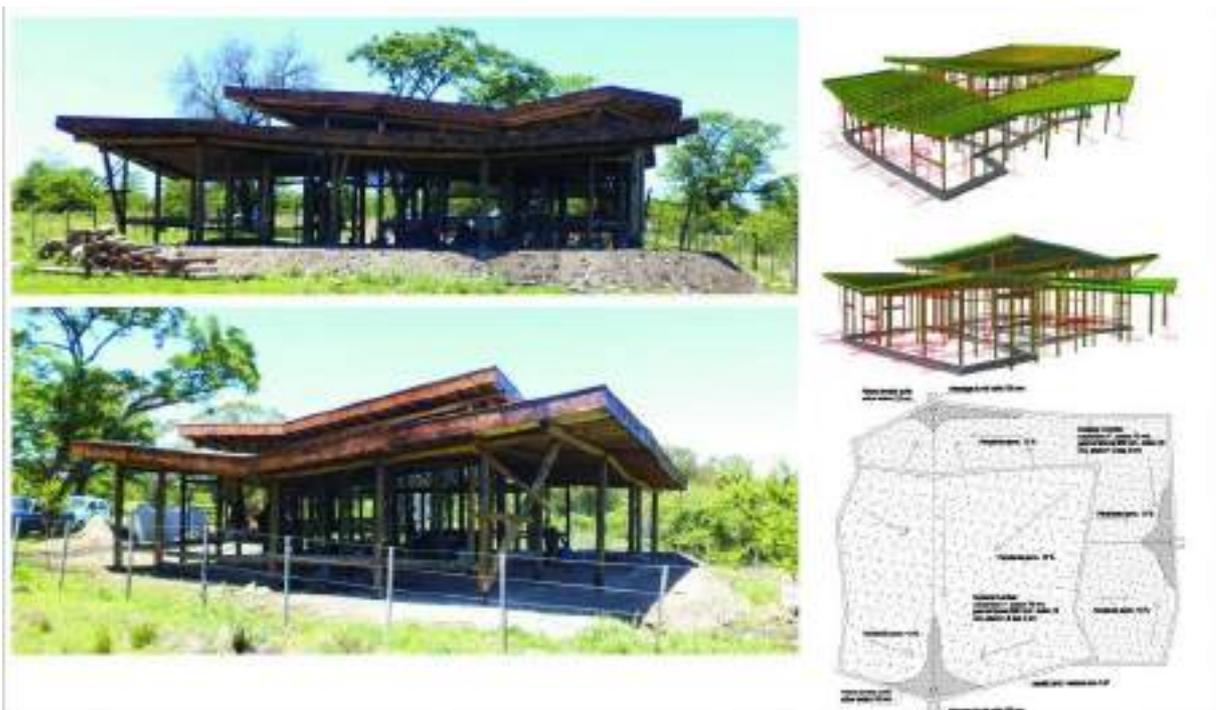
4. Plano de techos. Vistas de la estructura y cubierta terminada, 1° etapa de obra
