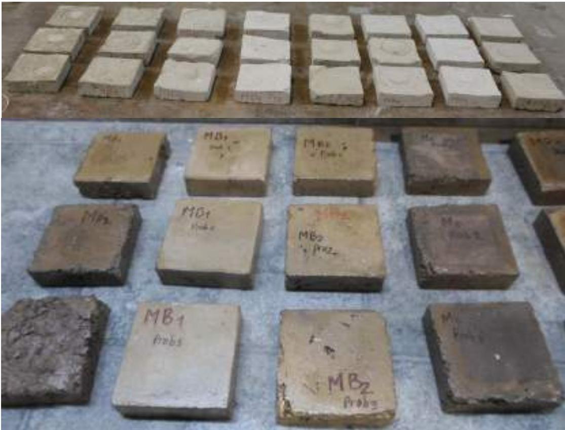
Figura 1. Probetas utilizadas para ensayo de desgaste por abrasión y absorción por capilaridad
