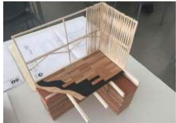
Figura 2. Maqueta de detalle constructivo de entepiso, primer piso tapial y segundo piso quincha prefabricada (mayo 2017)
