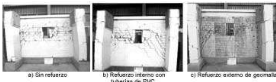
Figura 6. Muros de adobe ensayados
