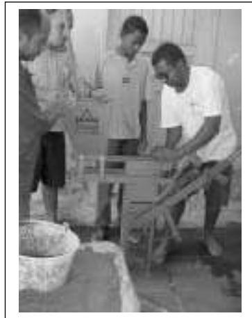
Fotos 3 y 4. Capacitación de comunitarios en la utilización de la prensa "cinva-ram", para confección de ladrillos de suelo-cemento-cal Asentamiento Jardim Esperança – Resende – RJ
