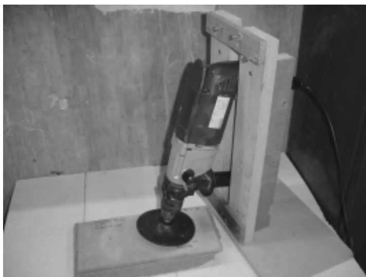
Figura 3: Dispositivo para ensayo de Desgaste por Abrasión
