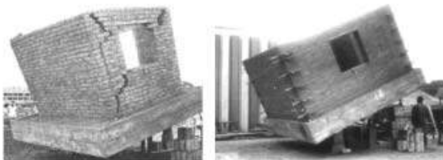
Figura 4. Módulos de adobe a escala natural sobre la plataforma inclinable
