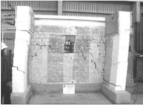
Fig. 3.9 Muro reforzado con geomalla vs. muro reforzado con malla electrosoldada
