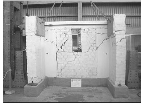
Fig. 3.9 Muro reforzado con geomalla vs. muro reforzado con malla electrosoldada
