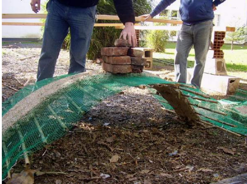
Figura 2 – Prototipo de malla plástica, caña y suelo cemento
