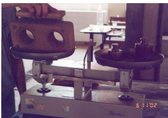
Figura 4 – Ensaio de durabilidade: escovação do bloco com escova de aço
