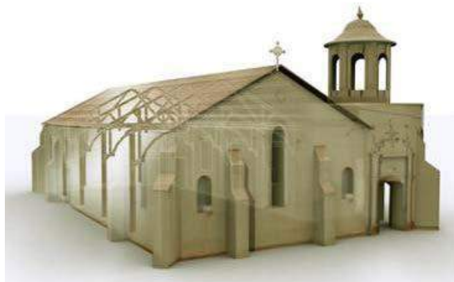
Figura 18 – Síntesis estructura Iglesia. Maqueta virtual elaborada por Surtierra arquitectura
