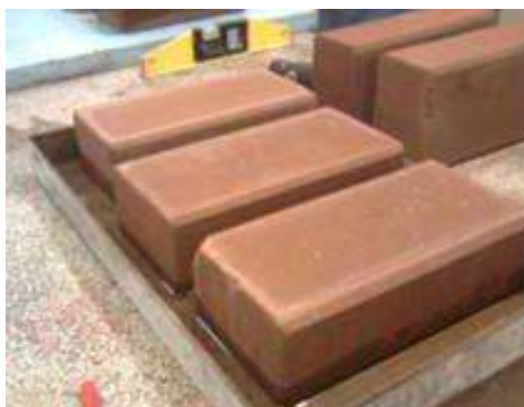
Figura 4 – Aspecto dos pisos com RCD
