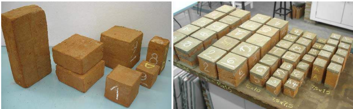
Figura 4 – Corpos-de-prova preparados, antes da ruptura.
