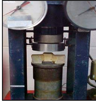
Figura 10 – Ensayo de adherencia
