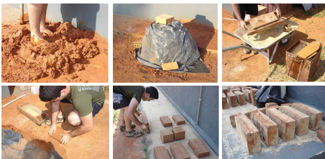
Figura 3 – Amassamento do barro e moldagem dos adobes e cubos.
