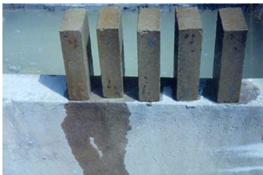
Figura 1 – BTC estabilizados con cemento Portland y sumergidos en agua durante 24 horas. Foto: Rubén Roux
