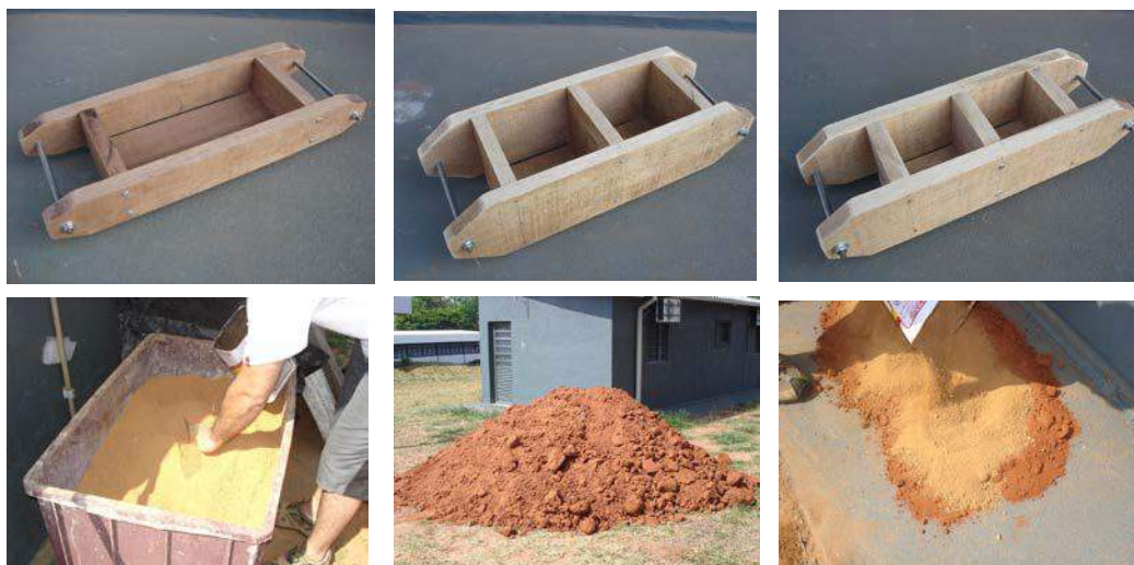
Figura 2 – Linha superior : fôrmas para produção dos adobes e cubos (de 10 cm e de 15 cm de lados). Linha inferior : detalhe dos dois solos utilizados; à esquerda o solo de Americana; ao meio o solo de Bauru e, à direita, detalhe da mistura.
