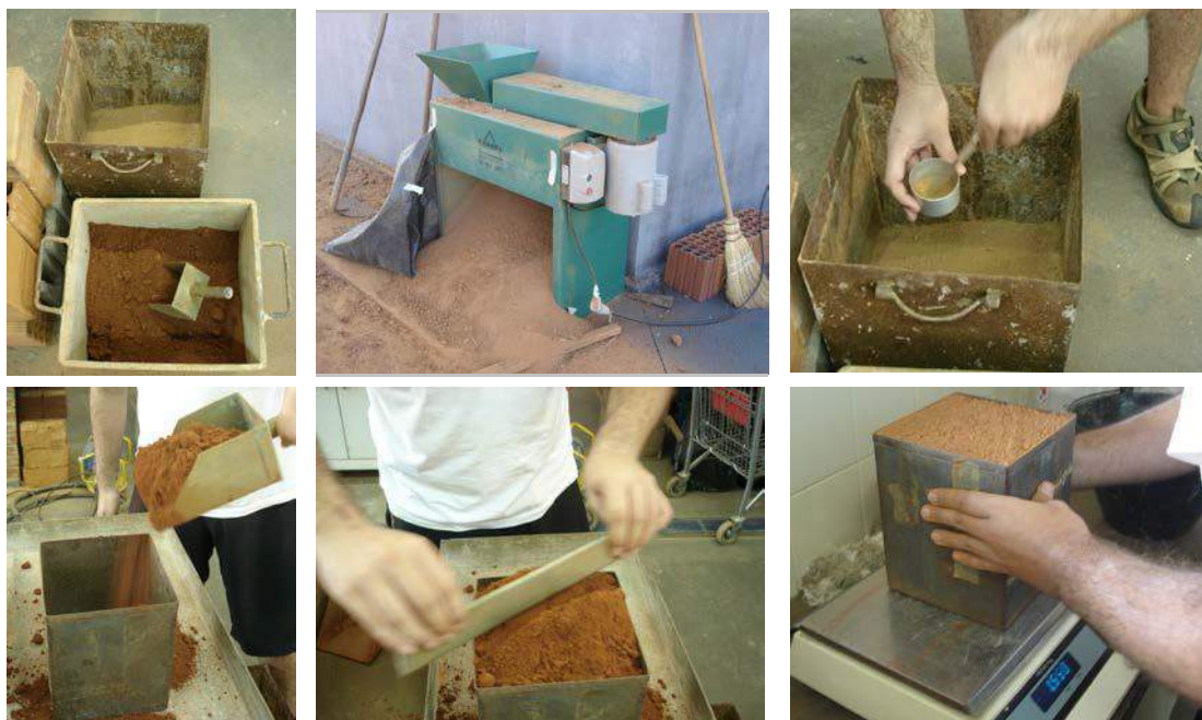
Figura 1 – De cima, no sentido horário: solos utilizados (Americana, mais claro e Bauru, mais escuro); destorroador de solos; coleta de amostras para determinação do teor de umidade natural; e, etapas do ensaio de determinação da massa unitária no estado solto.
