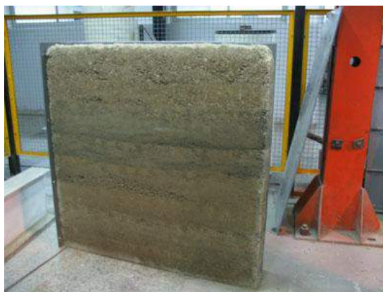
Figura 2 – Modelo constructivo de suelo-cemento con compactación manual
