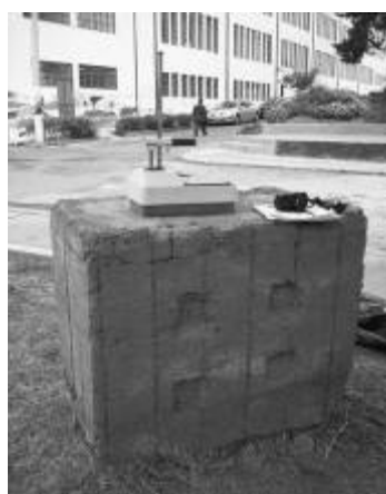
Figura 7. Ensayo de densidad en los muretes de tapia pisada, mediante densímetro nuclear
