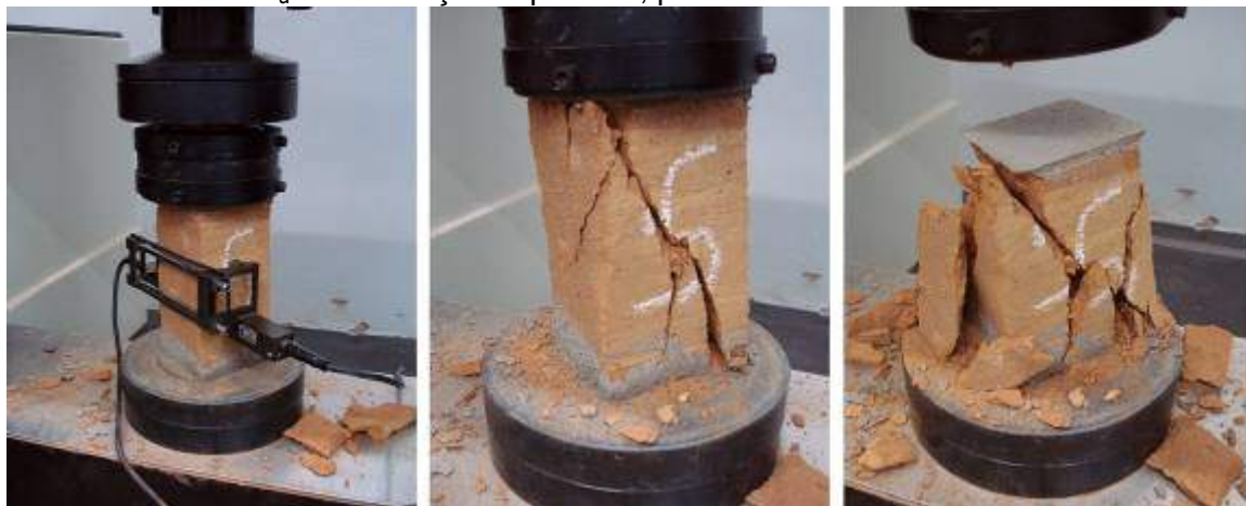
Figura 3. Alguns aspectos dos ensaios de determinação do módulo de elasticidade, notando-se o dispositivo de medição de deformações (extensômetros eletrônicos EMIC) e o padrão de ruptura dos CPs.
