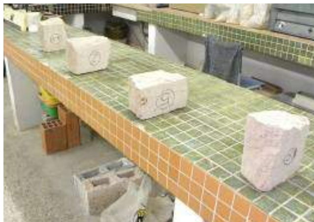
Figura 1 – Probetas sometidas a ensayos de humedecimiento y secado
