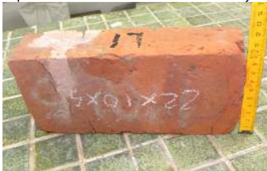
Figura 4 – Ladrillos sometidos a ensayo de capilaridad
