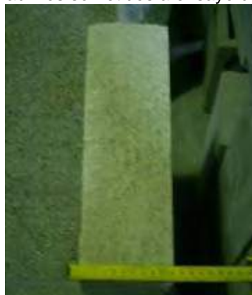
Figura 5 – Testigo de modelo constructivo sometidos a ensayo de capilaridad
