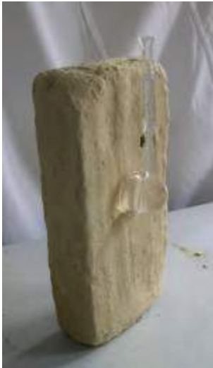
Fig. 2. Prove di assorbimento capillare.
