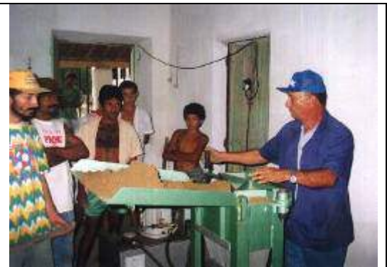
Foto 04- Produção de tijolos solo-cimento
