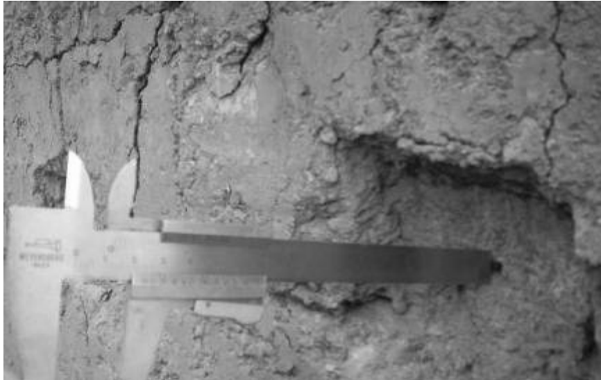
Figura 10. Lectura de la penetración y toma de testigos
