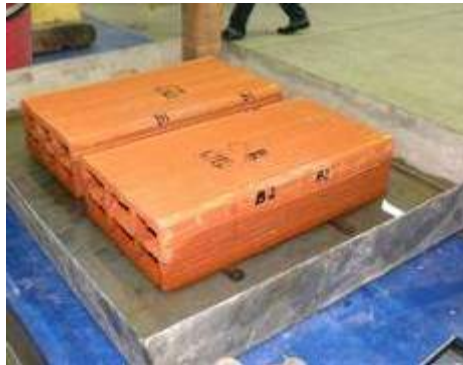
Figura 3 – Bloques cerámico hueco sometidos a ensayo de capilaridad
