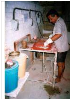
Fotos 03-Produção de telhas e vasos em argamassa de cimento
