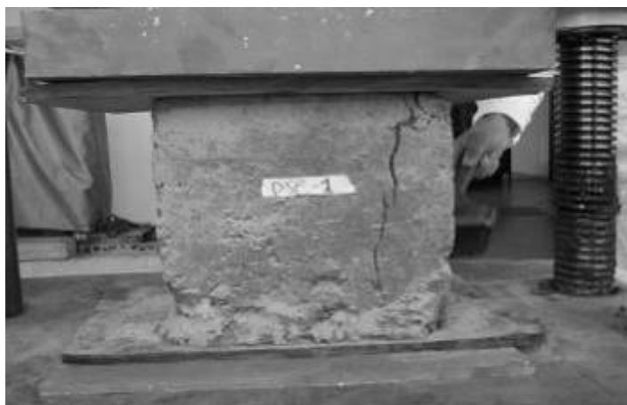
Figura 5. Proceso de carga de la probeta PSE -1 y mecanismo de falla
