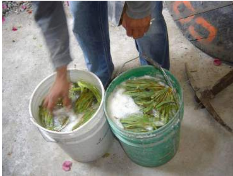
Impermeabilizante de mucilago de nopal y agua.
