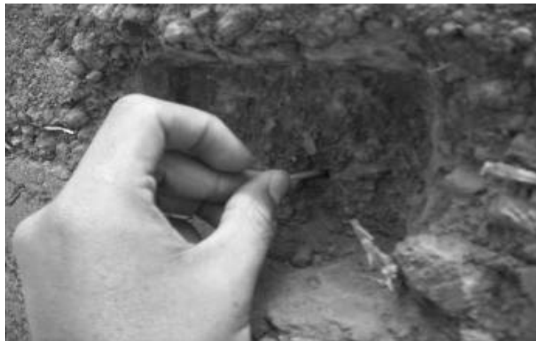
Figura 10. Lectura de la penetración y toma de testigos
