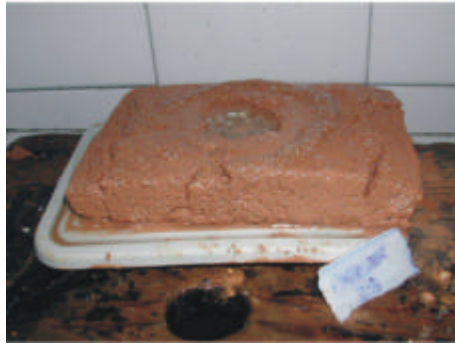
Fotografía n° 7 Medida del diámetro y profundidad del hueco producido
