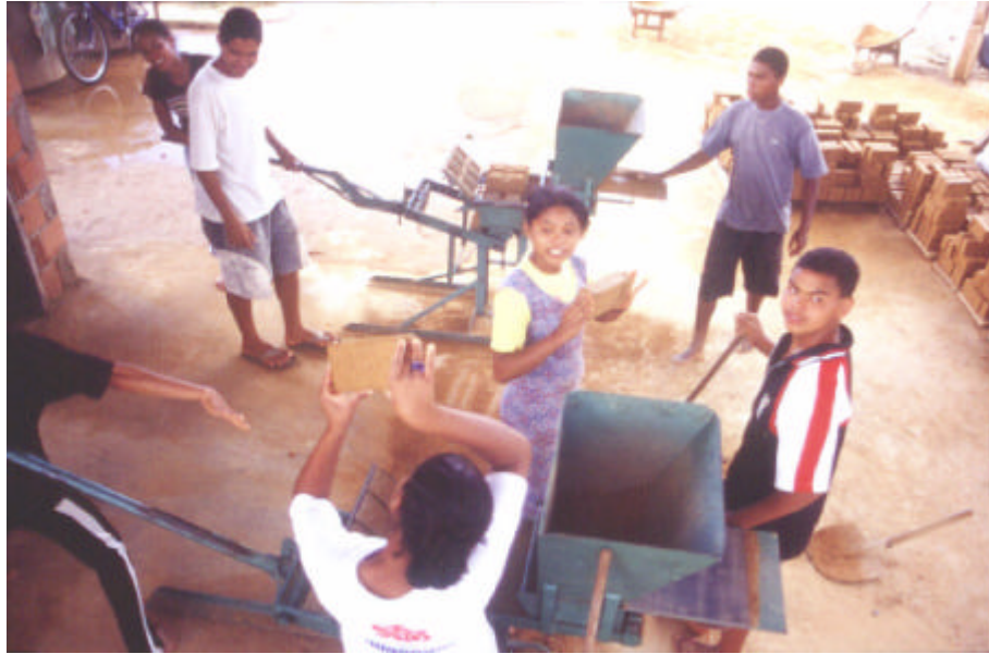
Foto 1: La producción de ladrillos de tierra estabilizada a cargo de la cooperativa de jóvenes UNIOVEM en SAD ( Jean D'Aragon, 2000 ).
