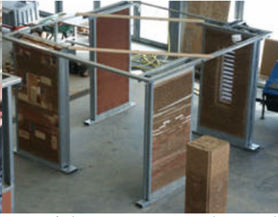
Tapial con estructura de metal
