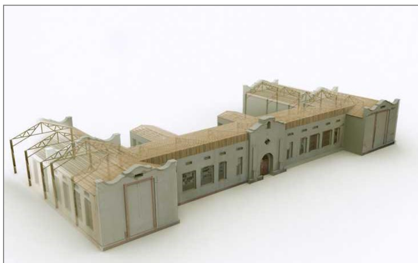
Figura 6. Modelo que ilustra la inserción de la estructura metálica dentro la albañilería de adobe en la Escuela Consolidada de María Elena. (Créditos: Oficina Surtierra Arquitectura)
