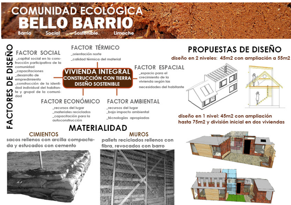
Figura 2. Factores de diseño, propuesta de diseño de la vivienda y materialidad.
