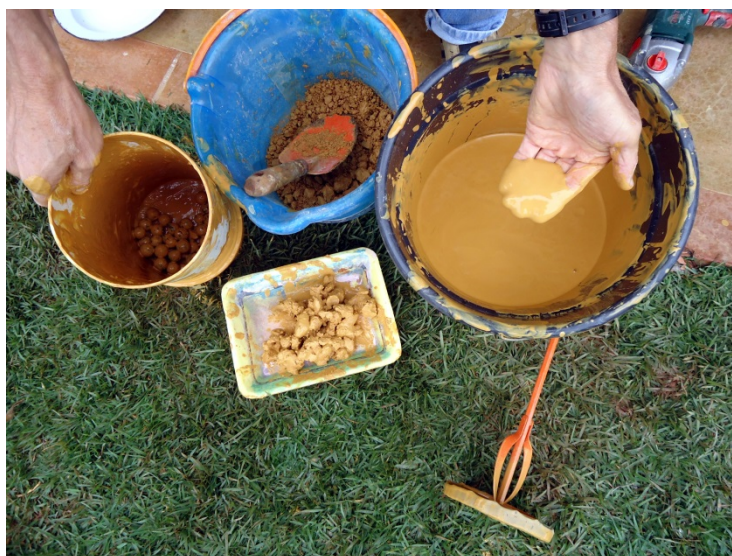
Figura 2. Detalhes da desagregação mecânica de solos; (esq. para dir.) Tubo de PVC de 150 mm de diâmetro com tela de malha 0,5 mm e bolas de vidro; recipiente com solo; solo desagregado e batedor adaptado com tela de malha de 0,5 mm
