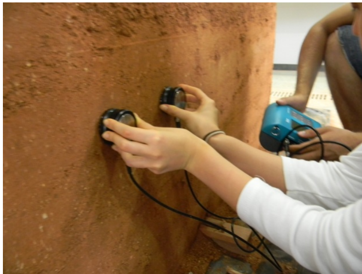
Figura 2: Teste de ultrassom no Painei 5. Fotografia: Peixoto, 2012.
