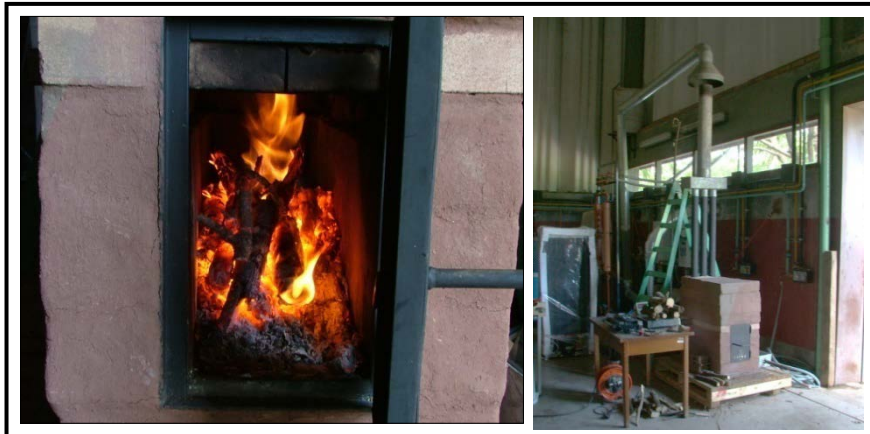
Figura 3: Imágenes durante las fases iniciales de la prueba y análisis del funcionamiento de la estufa. Laboratorio en INTI Energía (diciembre 2012). Imágenes: elaboración propia.
