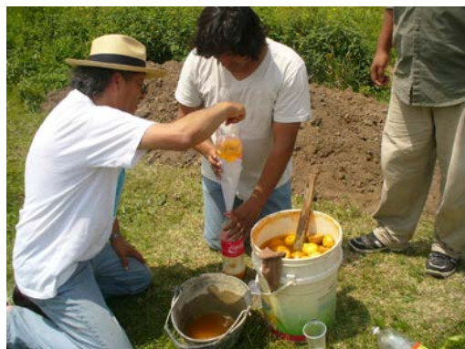
Figura 3: Separación en un recipiente cerrado el líquido fabricado a base de cal, limón y sal
