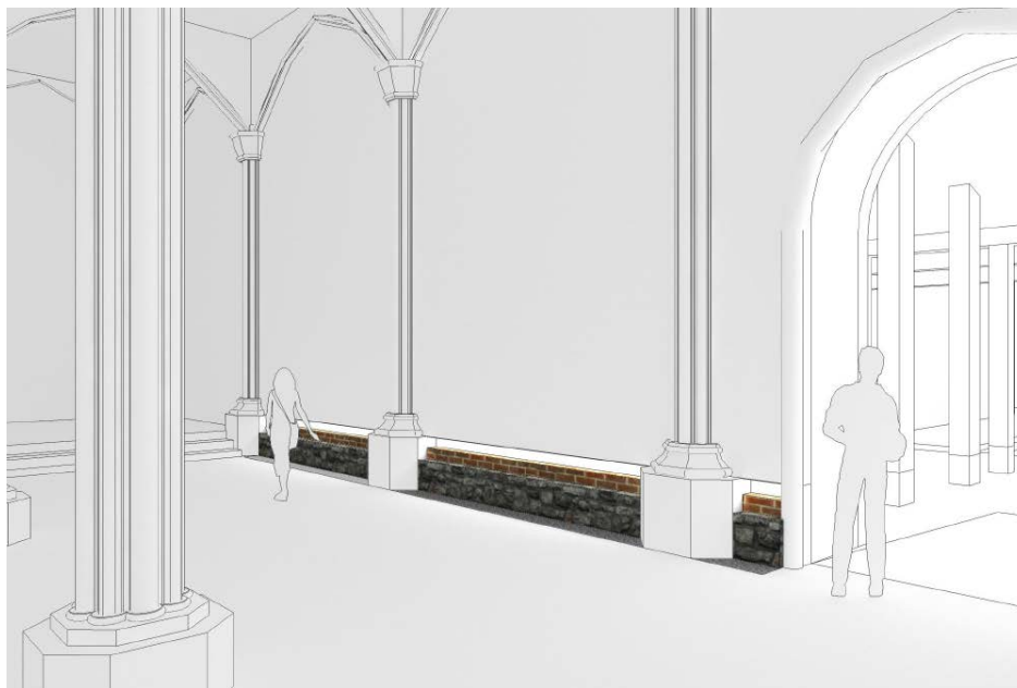
Figura 4. Imagen 3d que muestra la propuesta de vista interior del proyecto y sus cimientos originales vistos
