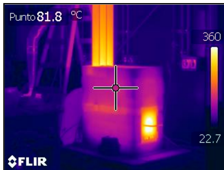
Figura 3: Termografía de la estufa durante los ensayos, realizada en simultáneo al ensayo de evolución del rendimiento y monóxido de carbono. Laboratorio en INTI Energía (diciembre 2012). Imagen: elaboración propia.
