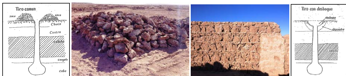
Figura 8. Las ilustraciones indican las calicatas que se realizaban para obtención del caliche, las fotografías muestran un acopio de costrón in situ y la foto de la mampostería que se realizaba en los muros de Pampa Unión. Fuente Ilustraciones: Macuer, 1930; fuente fotografías: registro propio, Pampa Unión, 2013.
