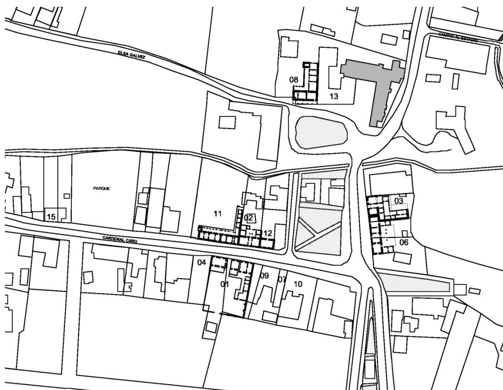
Fig.6 – Planta general de levantamiento, se observa la continuidad de los volúmenes que dan hacia la calle conformando el corredor. Las plantas de las casas en su mayoría tienen forma de L. (Créditos: equipo Arias Arquitectos)
