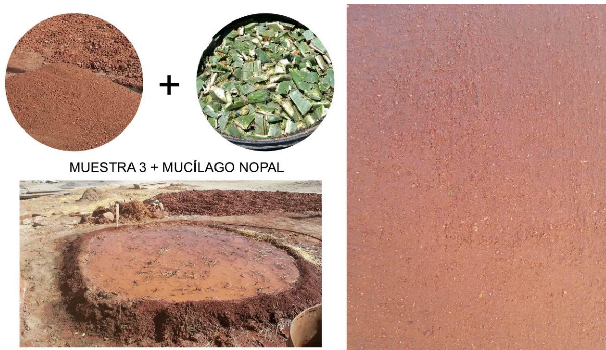
Figura 5. Muestra 3 con aditivo de mucílago de nopal, curado y terminación.
