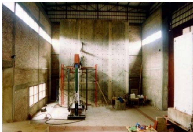
Figura 3. Losa de carga y muro reactivo
