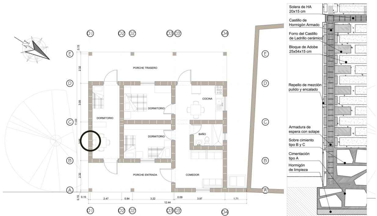
Figura 4. Planta y detalle constructivo de la vivienda de la familia de Don Rafael.
