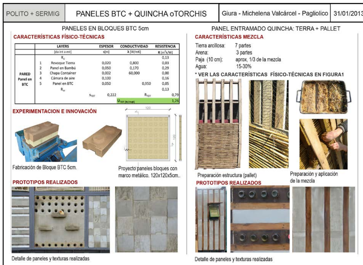
Figura 5: Características y prototipos de los paneles en BTC ½ y de las quinchas.
