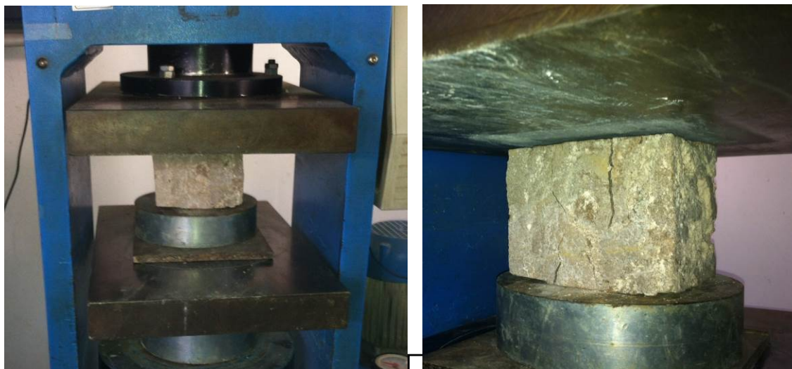
Figura 11. Izquierda: ensayo de compresión. Figura 12. Derecha: ensayo de compresión. Probeta después del ensayo.
