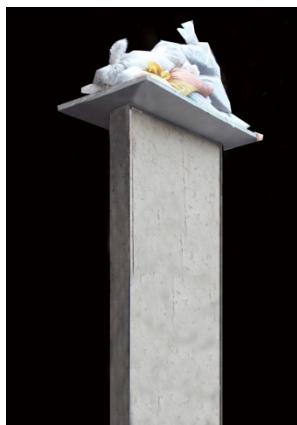
Figura 21 – Prueba de rotura con sacos de arena
