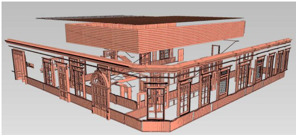
Figura 5. Muestra la totalidad de los elementos de madera a reemplazar por encontrarse afectadas por xilófagos, más los revestimientos de madera que dan altura a la Sala de Espectáculos.
