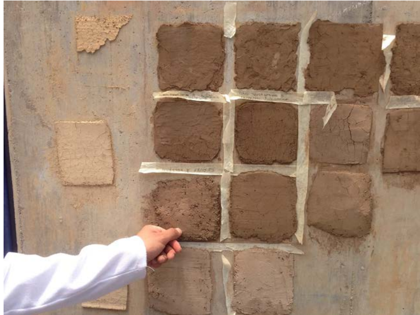
Figura 2. Algunas de las probetas aplicadas sobre muros de concreto en el Laboratorio de Materiales de la UAM-X. (Foto L. Guerrero 2015).
