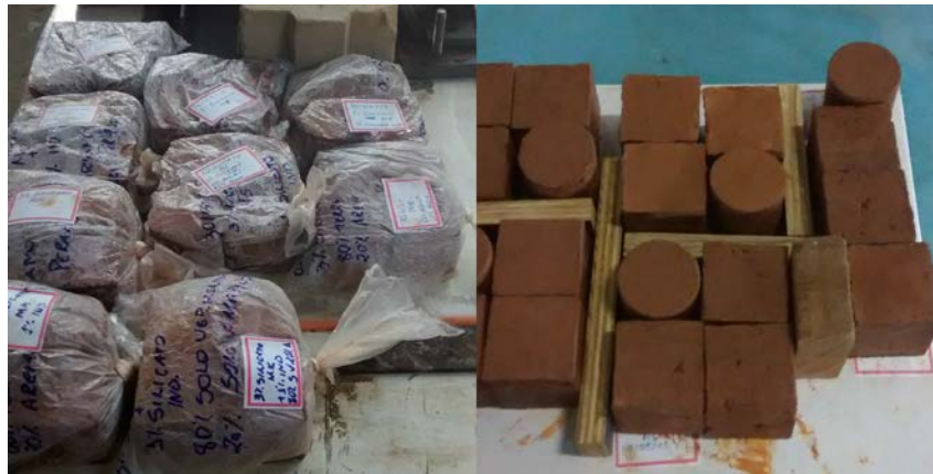
Figura 2. Amostras em cura em saco plastico até o terceiro dia após remoção
