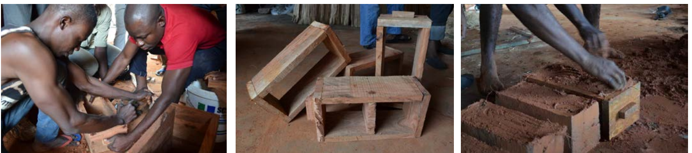
Figura 5: Processo de confecção dos adobes (Créditos: Sérgio Norberto, 2012)
