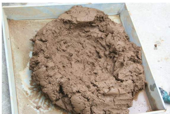
Figura 7. Macilla para adobes hecha de tepetate estabilizado con cemento.
