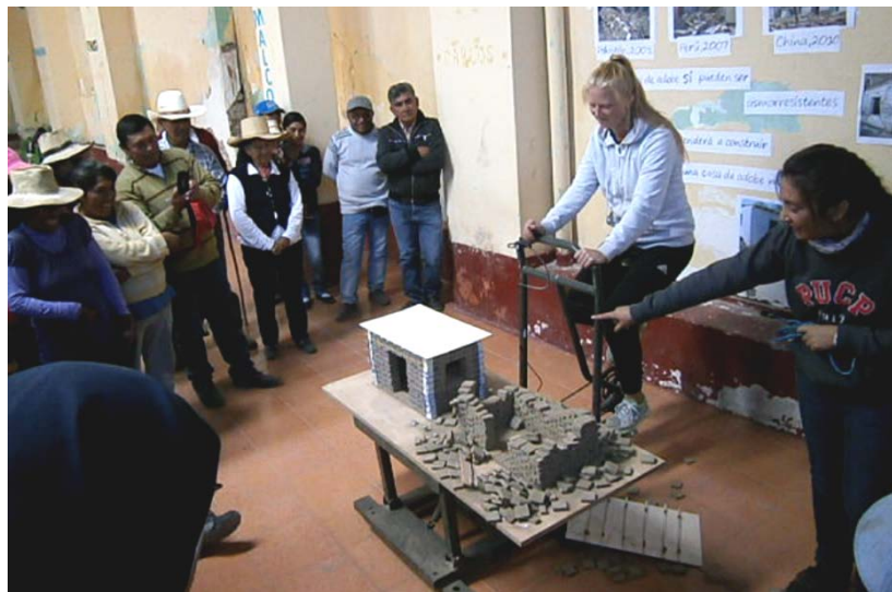
Figura 6. Demostración con la mesa vibratoria portátil PUCP
