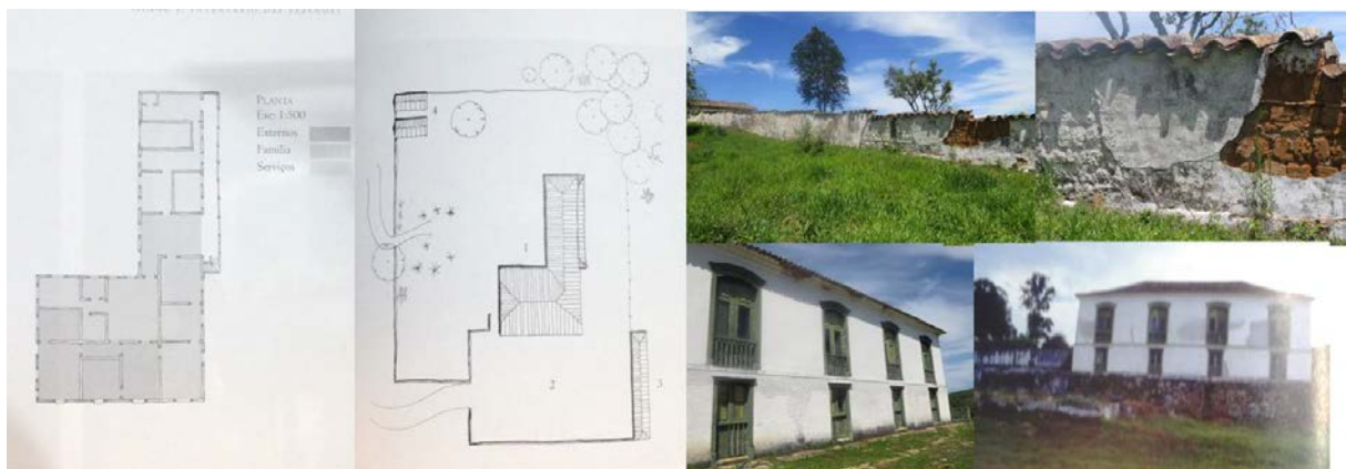
Figura 3. Fazenda Favacho. Planta, implantação fachadas principal e lateral, muros de adobes (Cruz, 2010; Pereira, 2014)
