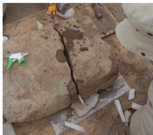
Figura 6 – Reparación de adobes con inyección de barro líquido para los ensayos de flexión
