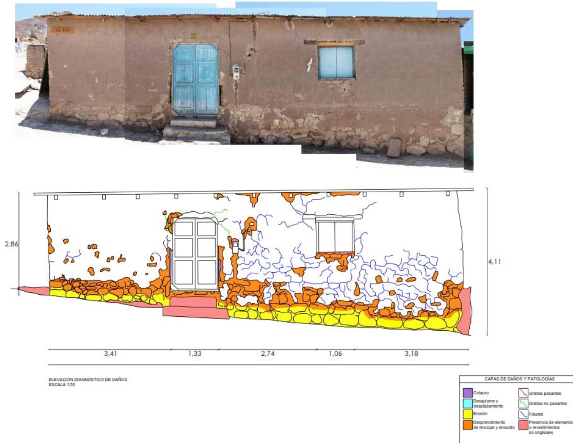
Figura 4. Lámina con diagnóstico de daños previo a la liberación de revocos (Fundación Altiplano)
