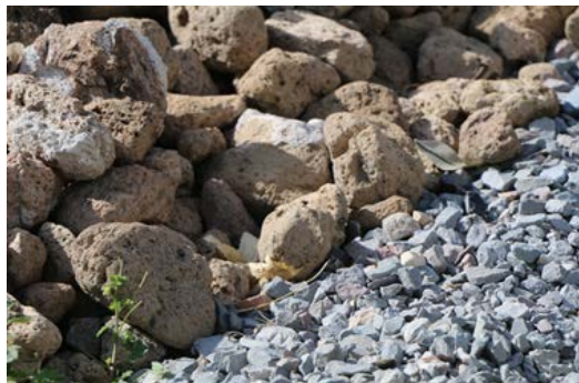
Figura 5. Materiales de la tapia de estudio. Piedra Poma y cacahuatillo
