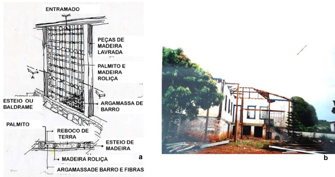
Figura 3 a) Detalhe da taipa de mão/pau a pique da Fazenda Rio Claro; b) O que restou da construção quando foi adquirida pelos atuais proprietários (Créditos: Parisi, 2015; Barreto, 2004)
