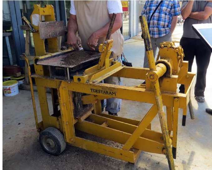
Figura 1. Blocadora manual para la producción de BTC en Les Grands Ateliers de Villefontaine (Fotografía: E. Blanco Tamayo)
