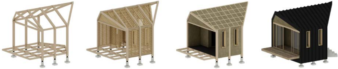
Figura 2: Cabina de guardaparques: esquemas de armado de estructura, osamentas, rellenos y revestimiento exterior, 2014 (Badetto, Larroza, Ocampos)
