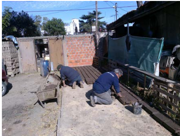
Figura 5. Fabricación con moldes dobles de madera dura sobre piso consolidado de carpeta cementicia
