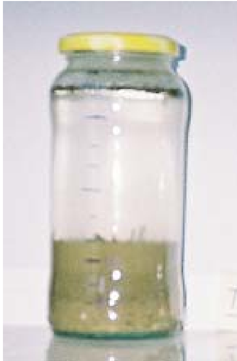
Foto 6 – Análises de campo – Sedimentação simplificada.
