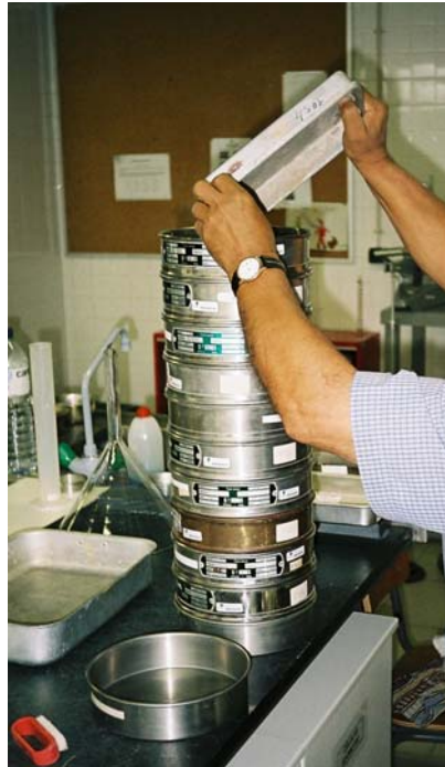
Foto 8 – Ensaio em laboratório - colocação de amostra nos peneiros. Quadro de referência dos peneiros ASTM utilizados no presente estudo e dos calibres dos respectivos crivos
