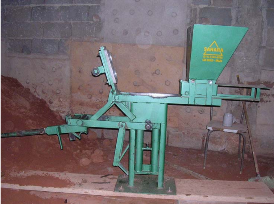
Fig. 1 – Prensa manual para tijolos modulares furados de 12,5 x 25 x 6,25 cm, produzida pela Sahara. Fotografia do autor.
