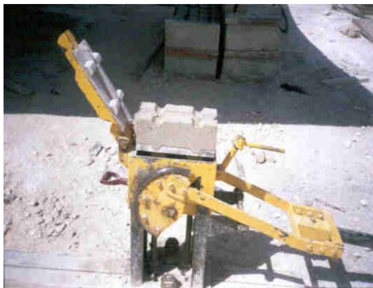
Figura 2: Máquina manual de producción de Bloques Machihembrados de suelo – cemento
