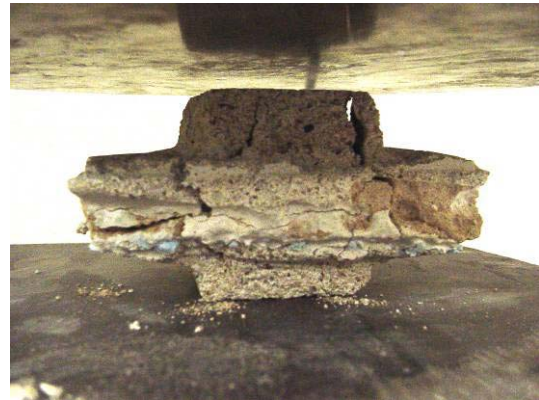
2. Provede de revestimento após rotura
