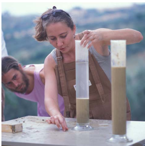
Fig. 1 – Cantiere di casa D’Arcangelo. Prove preliminari sulle terre: test di sedimentazione. Foto Mauro Bertagnin.
