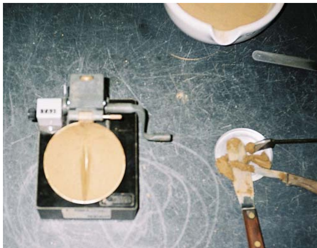
Foto 10 – Ensaio em laboratório – Concha de Casagrande – Limite de liquidez (WL).
