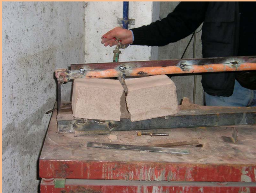
Teste de flexión (Instrumental para ser utilizado en campo). Crédito: Roberto Mattone
