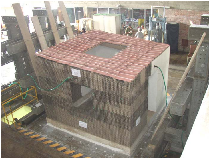
Fig. 4 - Módulo reforzado con malla exterior de plástico
