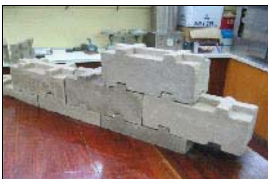
Fig.4- Sistema Lamars: bloques encastrados (CRIATiC-UNT), Tucumán.
