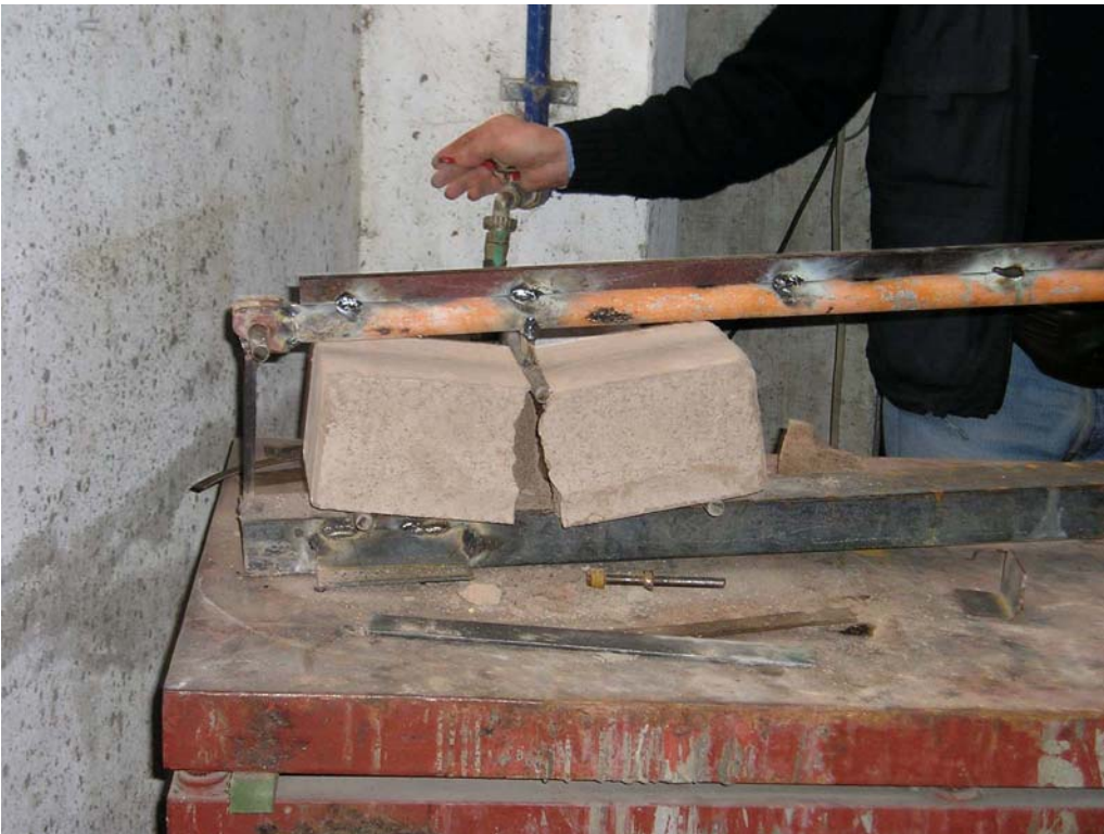
Fig. 2: Ensayo de flexión (Instrumental para ser utilizado en campo)
