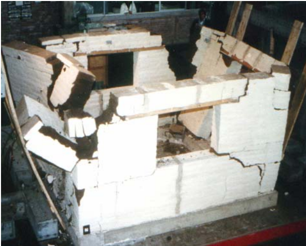
Fig. 3a - Módulo sin refuerzo
