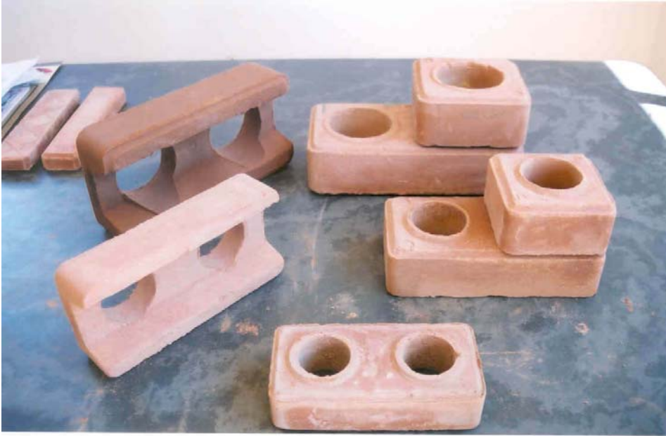
Fig. 3 - Tijolos modulares furados medindo 25 cm x 12,5cm x 6,25 cm, produzidos por prensas manuais. Fotografia do autor.
