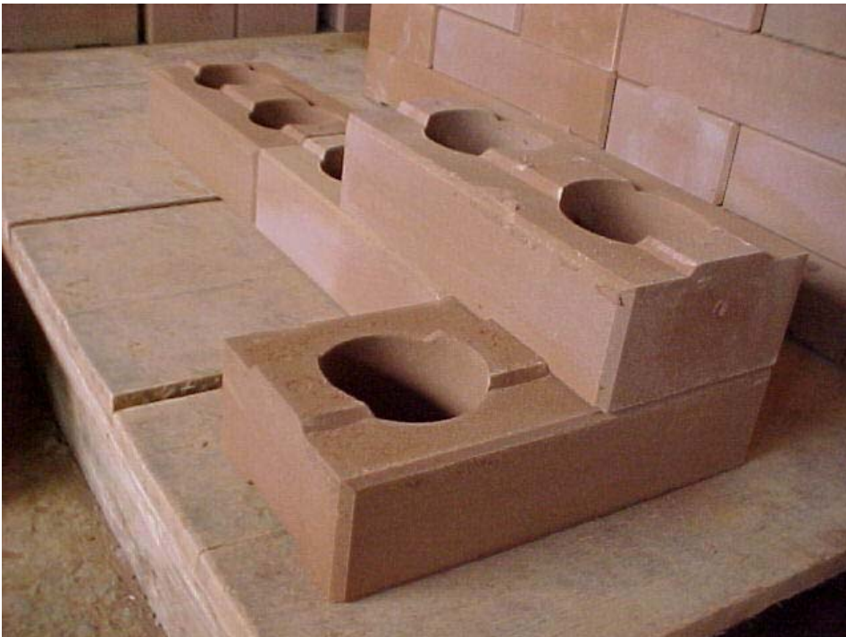
Fig. 4 - Tijolos modulares furados medindo 30 cm x 15 cm x 7,5 cm, produzidos por prensas mecânico;hidráulicas. Fotografia do autor.
