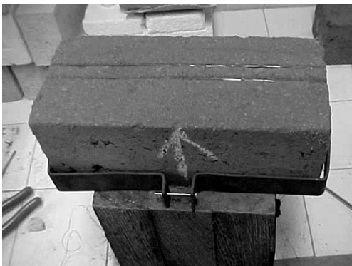
Figura 01- Vista superior do corpo-de-prova, com detalhe da colocação do termopar no meio do tijolo e, a 16 mm acima desse, o fio quente e as garras metálicas que mantêm os fios esticados.
