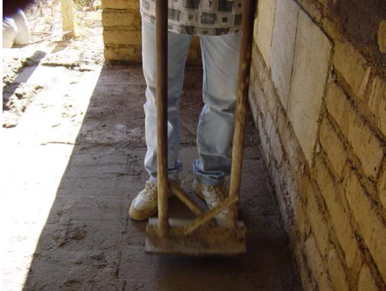
Foto No. 2 Apisonador de mayores dimensiones, utilizado para agilizar el proceso de fabricación.
