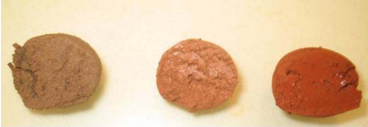
Figura 2. Resultado do ensaio "Teste do brilho". Para os solos 1, 2 e 3, respectivamente.
