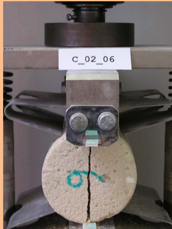
Ensaio compressão simples e de compressão diametral. Fonte Universidade de Aveiro
