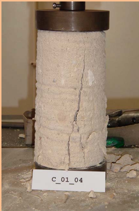
Ensaio compressão simples e de compressão diametral. Fonte Universidade de Aveiro
