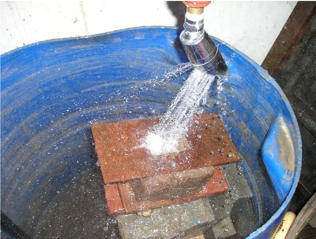
Fig. 1: Ensayo de chorro de agua
