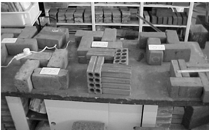
Figura 03- Bancada geral, montada com os diferentes tijolos para o ensaio acústico.
