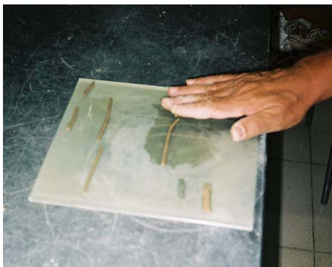
Foto 11 – Ensaio em laboratório – Preparação para a determinação do Limite de Plasticidade (WP).
