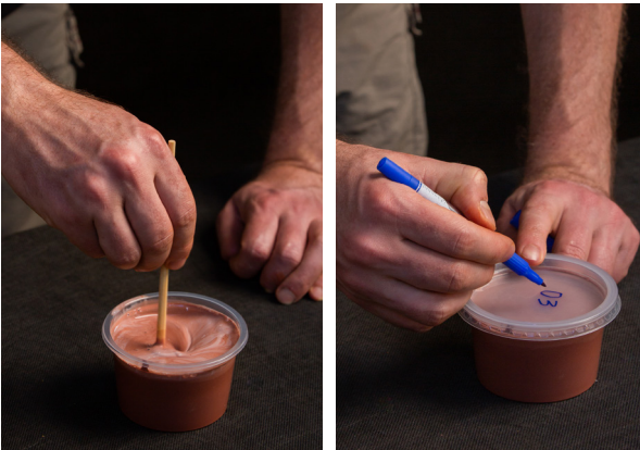
PASO 4. Verter el material en un recipiente, añadir 30 ml de PVAc y mezclar bien con un palillo o una cuchara. PASO 5. Tapar el recipiente e identificar la muestra preparada.
