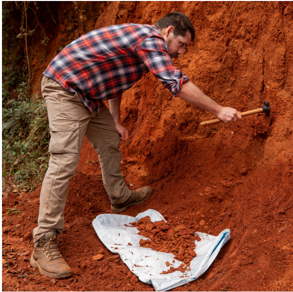
PASO 3. Cubrir la base del barranco con una bolsa de plástico, cavar con una azada o azadón y extraer las muestras de manera uniforme en diferentes posiciones sin cavar agujeros para evitar dañar la estructura del barranco y provocar así desprendimientos y erosión. Tomar las muestras con cuidado para evitar la contaminación con materiales orgánicos u otros tipos de suelos. Limpie siempre a fondo las herramientas después de cada recogida.
