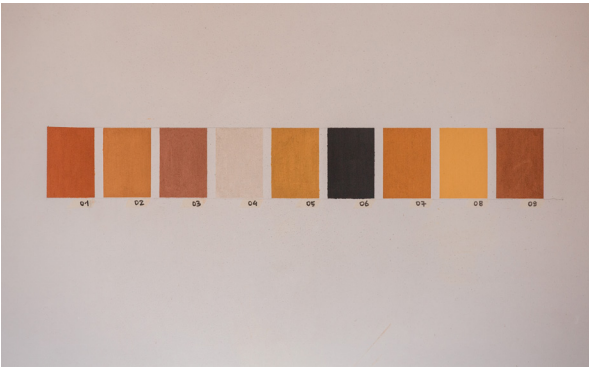
PASO 4. Repetir las operaciones anteriores con todas las muestras, esperar a que se sequen y retirar con cuidado la cinta adhesiva.
