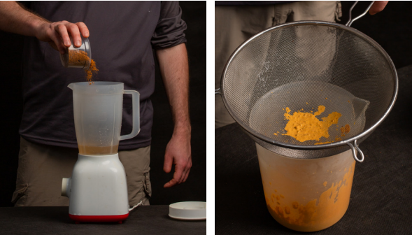
PASO 2. Diluir el volumen de tierra triturada en 200 ml de agua a mano, con una licuadora o batidora. PASO 3. A continuación, tamizar el material diluido a través de un tamiz fino para separar la arena y la materia orgánica. La viscosidad debe ser similar a la de la pintura convencional y debe ajustarse si es necesario. Si es demasiado consistente sólo hay que añadir más agua y si es demasiado líquida sólo hay que añadir tierra, mezclar bien y colar.
