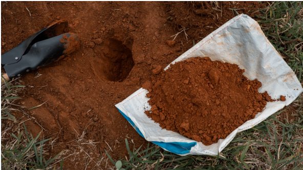
PASO 2. Excave con una azada o cavador manual para extraer las muestras, teniendo cuidado de evitar la contaminación con materiales orgánicos u otros tipos de suelos. Forrar siempre con bolsas de plástico y limpiar bien las herramientas después de cada recogida.
