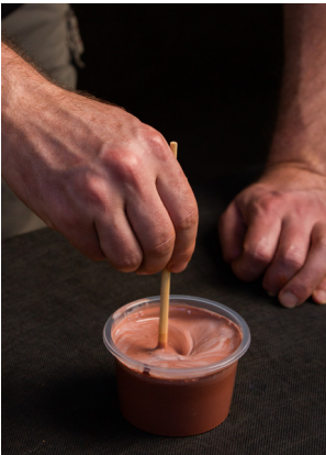
ETAPA 4. Verter o material em um recipiente, adicionar 30 ml de PVAc e misturar bem com um palito ou colher.
