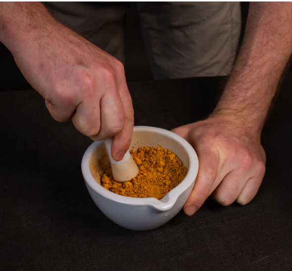
ETAPA 1. Destorrear um volume de 100 ml de solo seco. Quanto mais destorrear, maior a precisão das medidas de volume e maior a homogeneidade.
