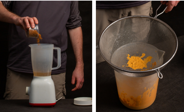
ETAPA 2. Diluir o volume de solo destorreado em 200 ml de água manualmente ou por meio de liquidificador.
