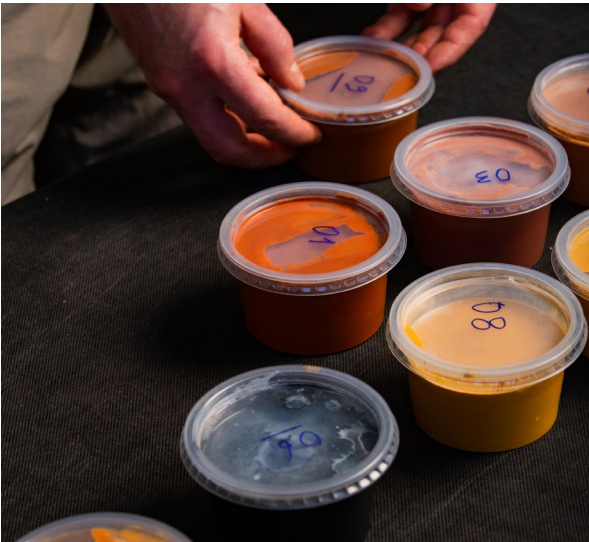
ETAPA 6. Repetir as operações anteriores com todas as amostras coletadas e reservar, evitando deixar as amostras expostas ao sol. Estas amostras não são tintas propriamente ditas. Elas servem apenas para avaliar o efeito da cor e do poder de cobertura dos pigmentos obtidos dos solos coletados.
