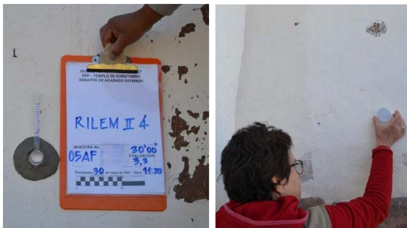
Figura 5 – Ejecución de las pruebas de evaluación de las muestras en mayo 2021: prueba de adhesión por puntero acústico (izquierda), prueba de absorción de agua a baja presión RILEM II.4 (centro) y prueba de porosidad abierta por esponja de contacto UNI 11432 (2011) (derecha). Fotografías Luís Villacorta Santamato © 2021, J. Paul Getty Trust
