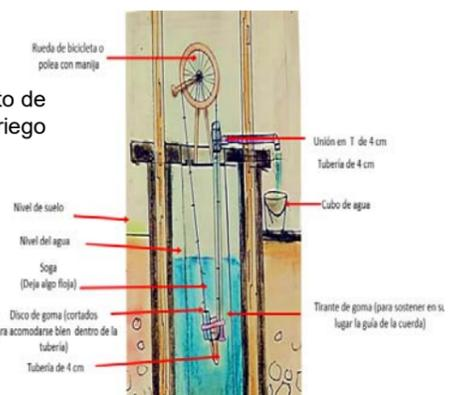
Fig. 6. "Bombas de sogá" de extracción de agua para el consumo
