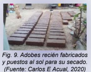
Fig. 9. Adobes recién fabricados y puestos al sol para su secado. (Fuente: Carlos E. Acual, 2020)
