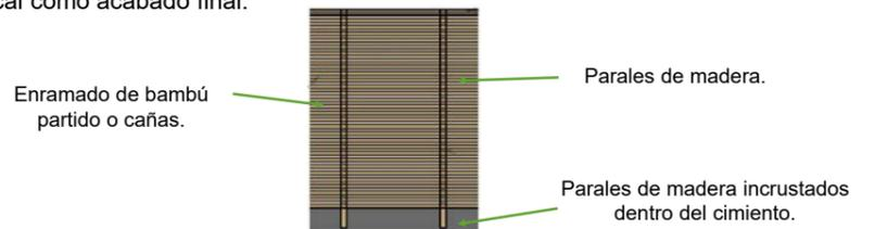
Fig. 13. Perfil de un muro de bajareque. (Fuente: Carlos E. Acual, 2021)
