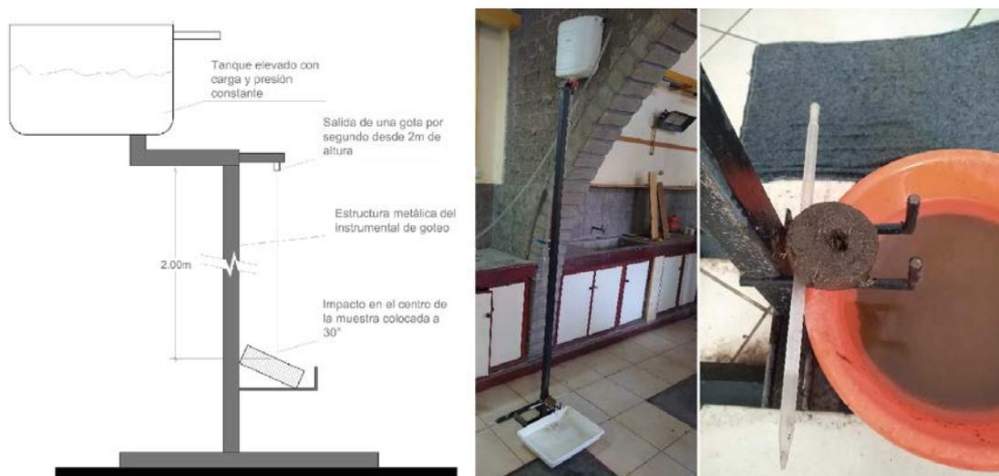
Figura 4. Instrumental para ensayo de goteo
