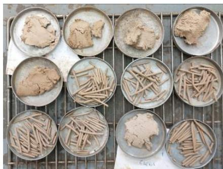
Figura 2. Muestras para determinación del límite plástico
