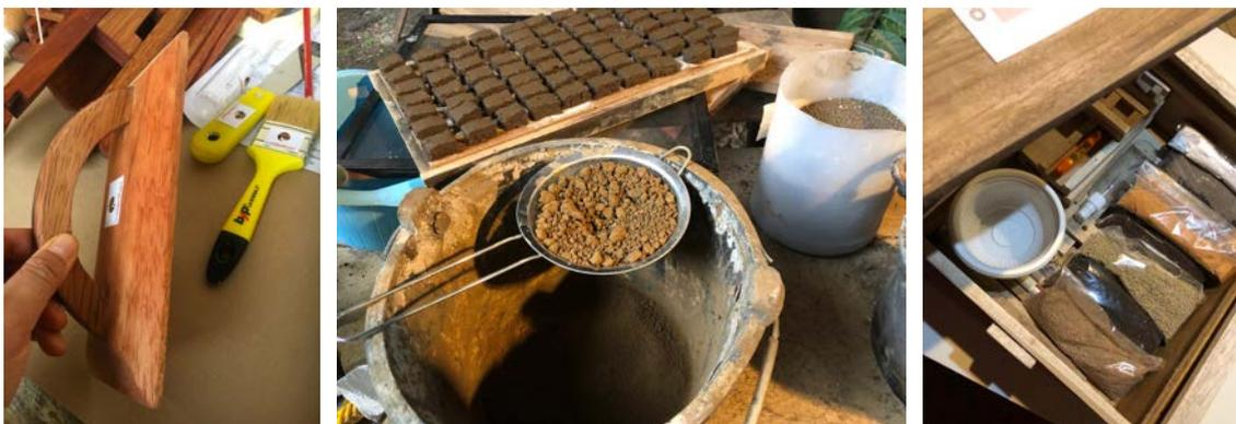
Figura 1. Detalles de la preparación de los talleres de Volver a la Tierra VIII (2020): llana de madera, adobes, herramientas
