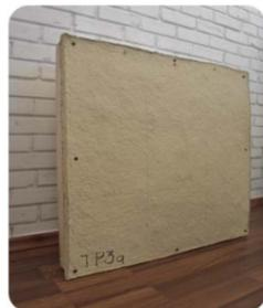
Fig. 4. Atornillado y montaje de panel TP3 en marco de madera
