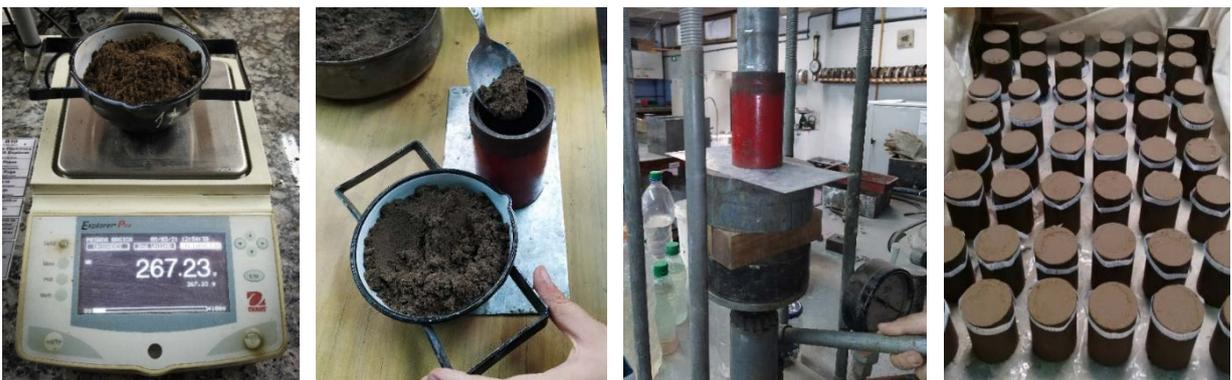
Figura 2: Probetas cilíndricas producidas en el laboratorio de materiales de la UTN FRSF
