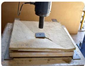
Fig. 2. Momento de ruptura de panel TP3c
