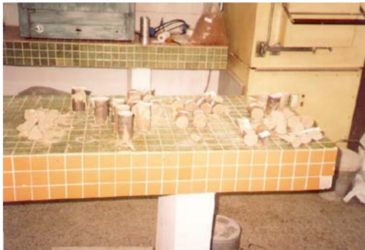
Fig. 3 Muestras ensayadas a la compresión en laboratorio
