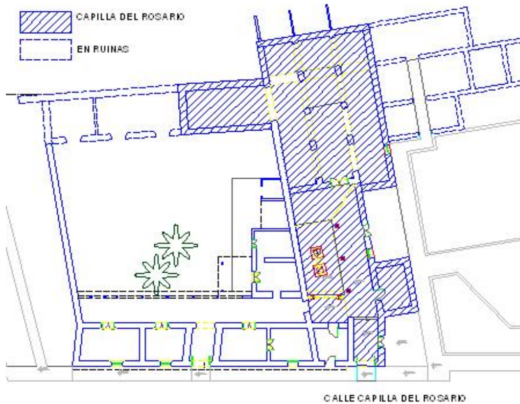
FIGURA N°2- situación actual de la casa, muros en ruinas, construcción que pertenece a la capilla.
