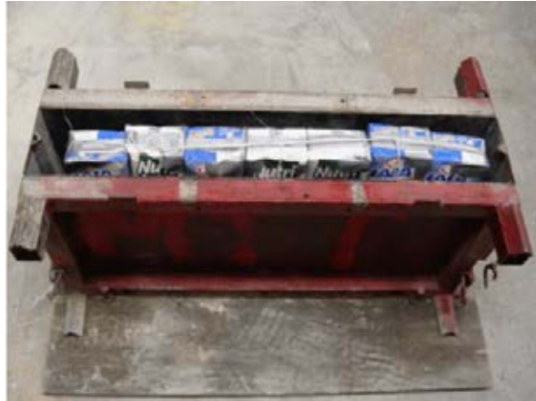
Figura 2 Molde empleado para la realización de paneles de concreto rellenos con tierra confinada envases de tetrabrick
