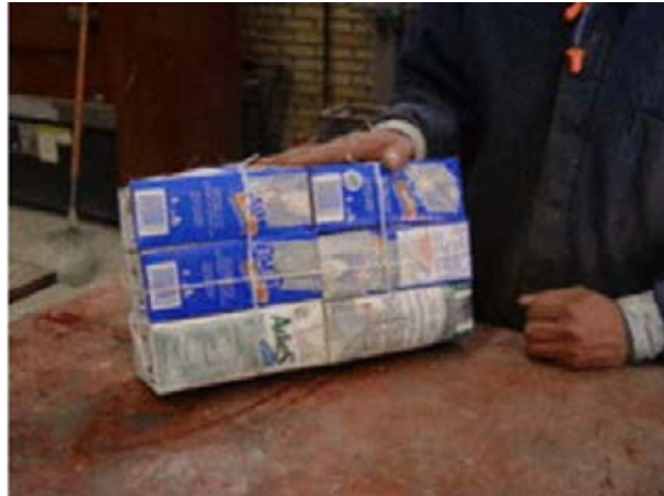
Figura 1. Amarre de envases de tetrabrick relleno con tierra
