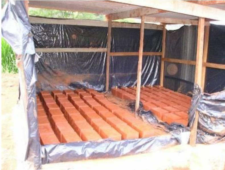
(Fig.4) Tijolos já desenformados e curando à sombra.
