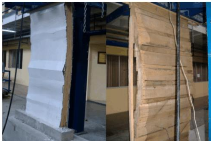
Figura 1 Modulo de tarima de madera sometidos a ensayos de resistencia a la compresión
