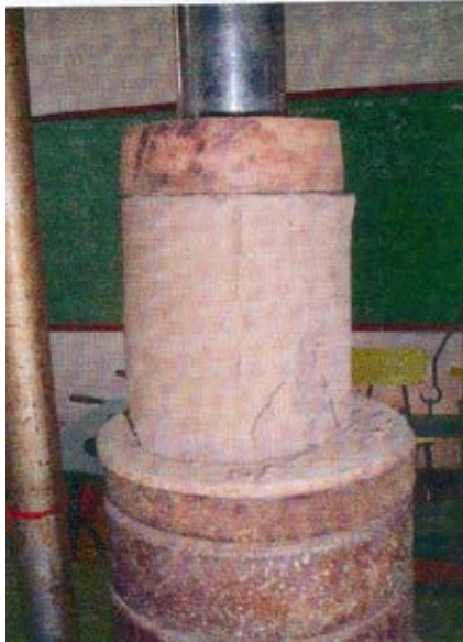
Fig. 1: Comprimiendo probetas cilíndricas
