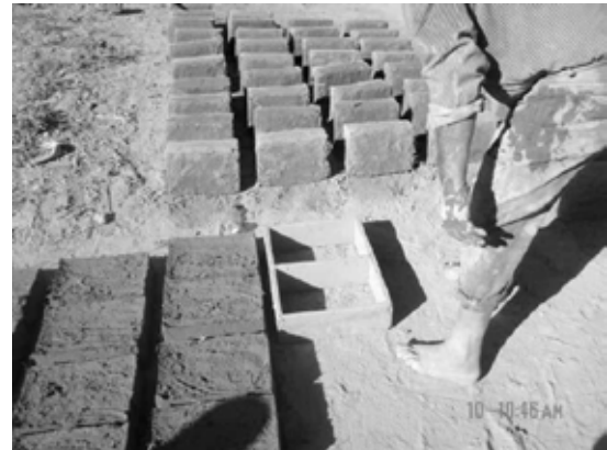
Fig.4. Vista de la "adobera", adobes frescos y en proceso de secado
