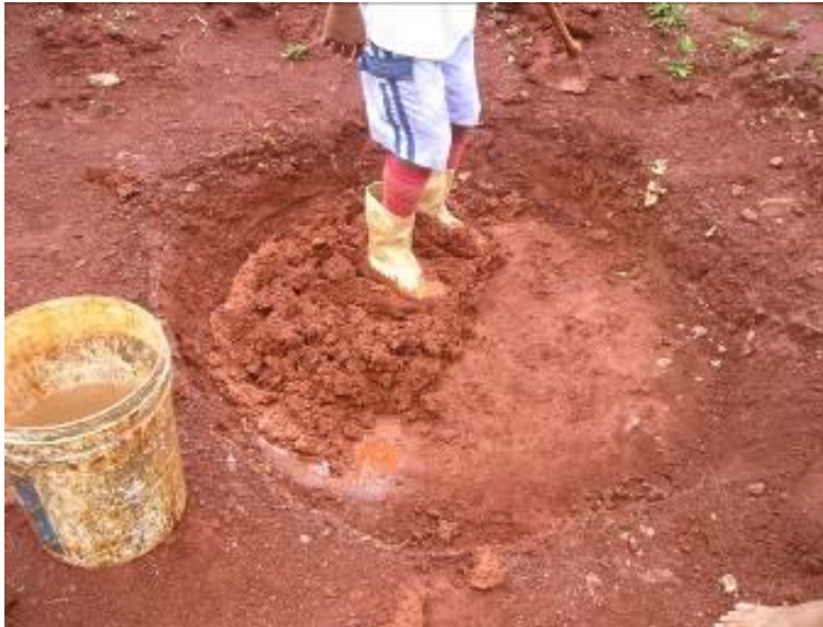
(Fig. 3) Vista da execução da massa que dá origem aos tijolos de solo-cal.
