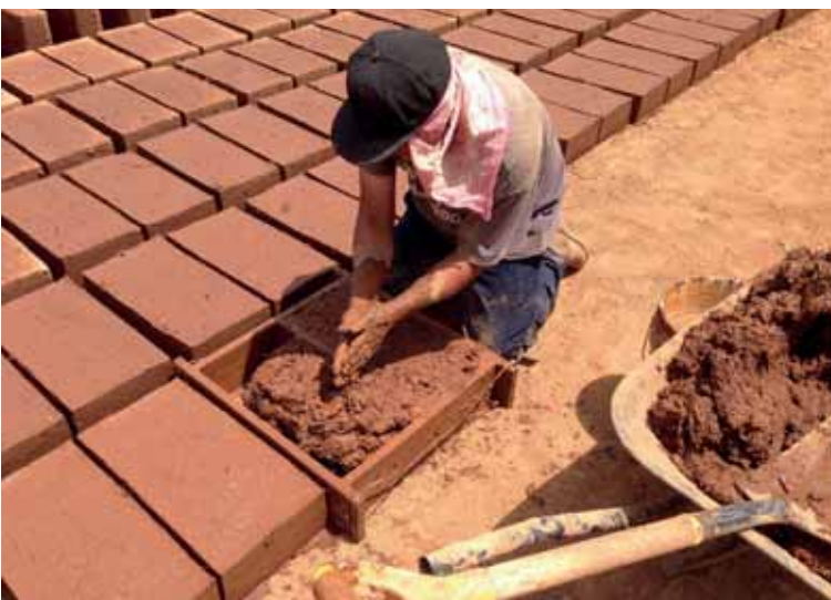
La mezcla para hacer adobes debe dejarse reposar para que tenga una adecuada plasticidad. Guadalupe, Zacatecas.
