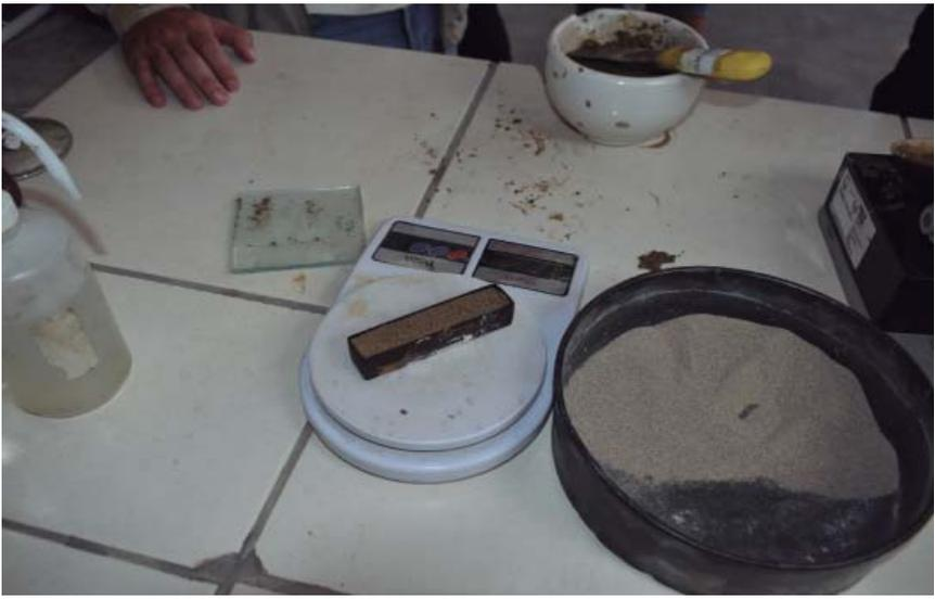
Prueba de retracción lineal o de Alcock
