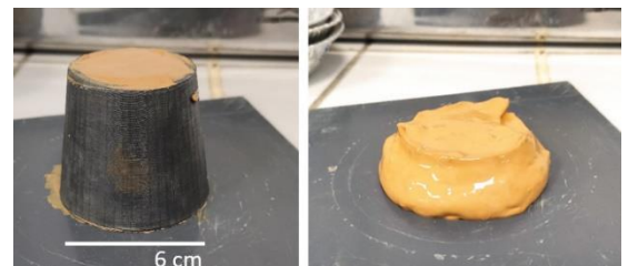
Avaliação da consistência por espalhamento (inspirado na tecnologia do betão/concreto) utilizado para argamassa de terra. Crédito: cortesia da RILEM Tech Lett
