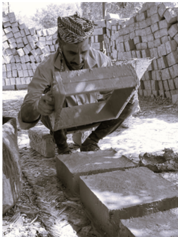
Demostración de ejecución de adobes por el albañil Muhannad Ali Hamza. Crédito: Amanda Rivera Vidal.
