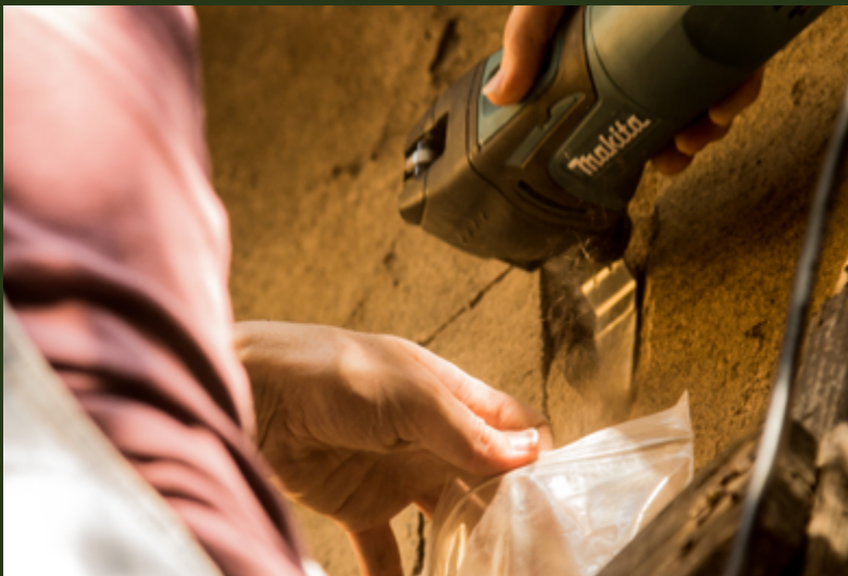
Extracção de amostras de rebocos em Santiago do Chile. Crédito: C. León.
