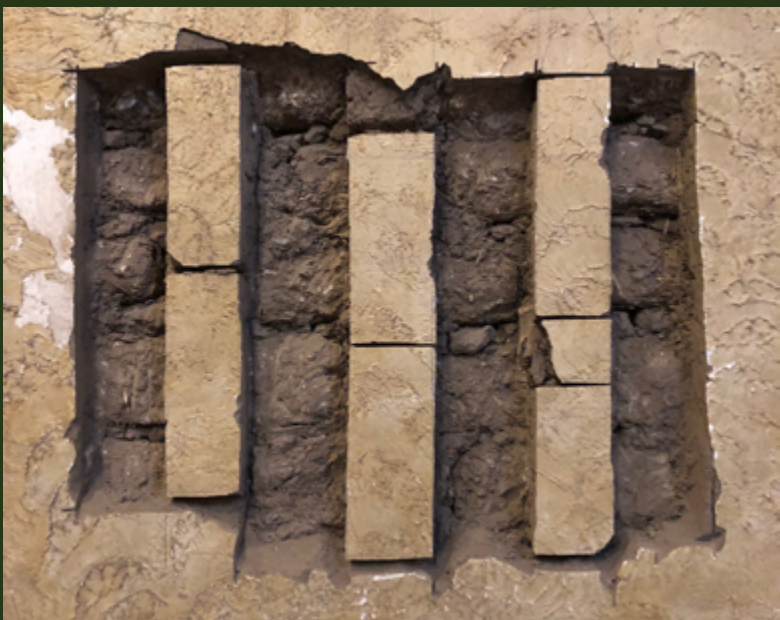
Amostras antes de serem destacadas da parede. Crédito fotografia P. Marchante.
