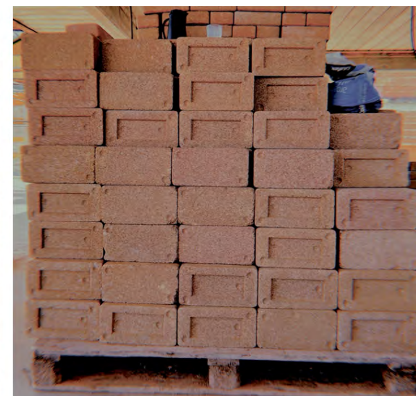
Produção: Galpão em funcionamento com a produtos de BTC furado e maciço. Fotografia: Rafael Fogel
