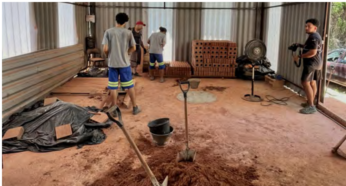
Produção: Galpão em funcionamento com a produtos de BTC furado e maciço. Fotografia: Rafael Fogel
