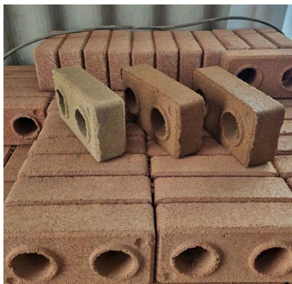
Produção: Galpão em funcionamento com a produtos de BTC furado e maciço. Fotografia: Rafael Fogel
